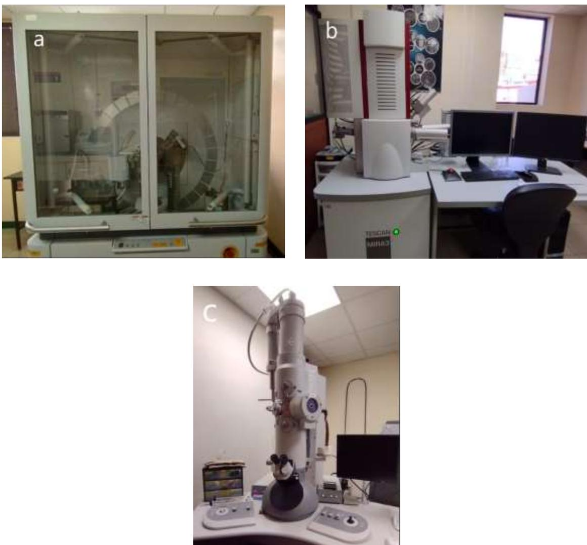
*Nota.* Las imágenes representan los equipos del laboratorio de microscopía de la Universidad de las Fuerzas Armadas ESPE usados para la caracterización de las NPs. a) Difractómetro de rayos X, Empyrean. b) Microscopio electrónico de barrido, Mira 3 Tescan. c) Microscopio electrónico de transmisión, FEI Tecnai. Fotografías propias.
