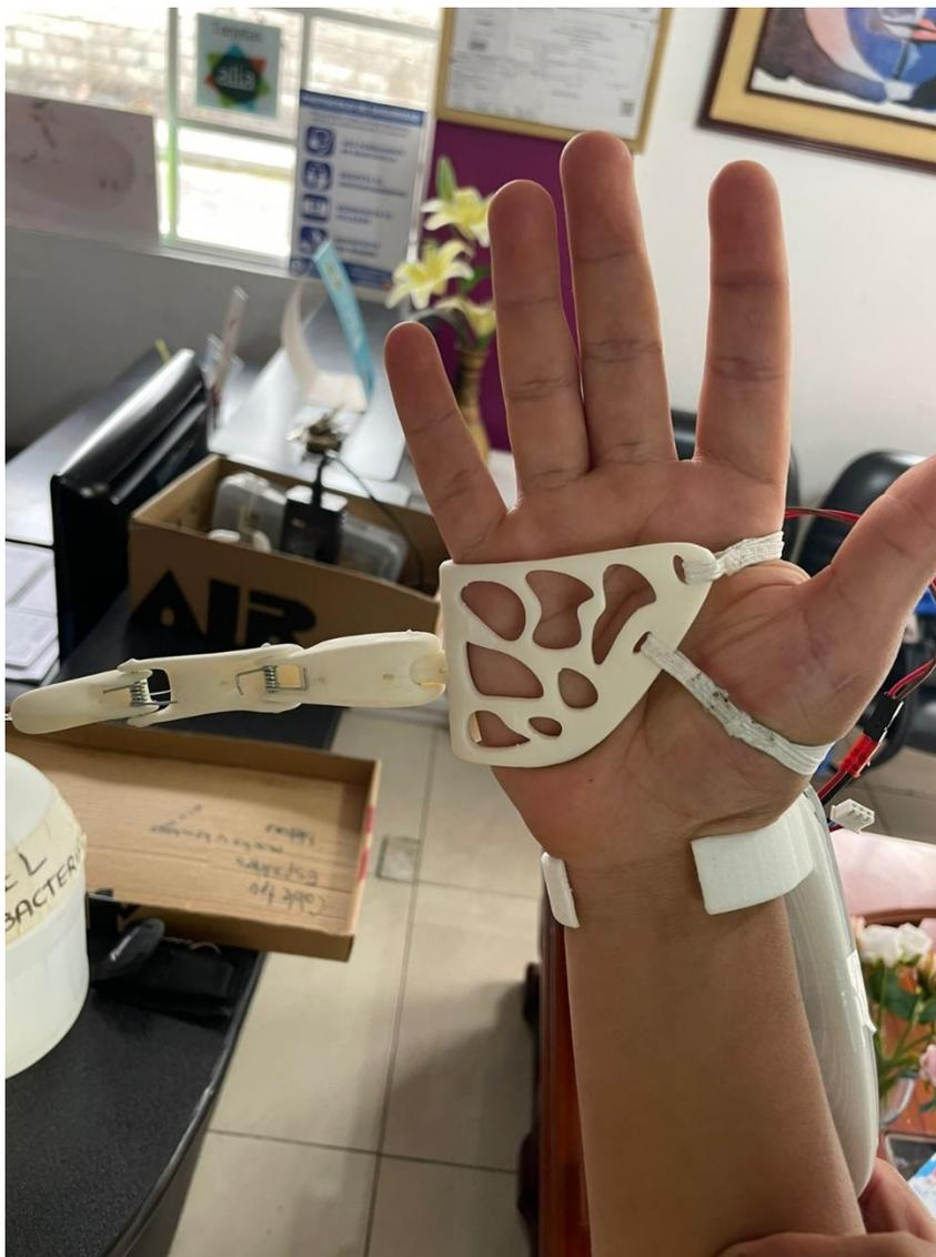
*Nota.* La figura muestra la colocación del ensamble previo al sistema de control en la mano
