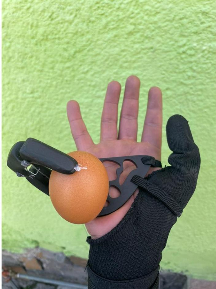
*Nota.* La figura muestra la prueba 2, resistencia y agarre con un huevo.
