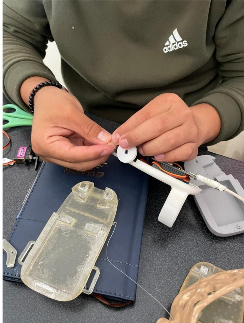
*Nota.* La figura muestra la colocación de las poleas en el eje de los servomotores, así como el nylon
