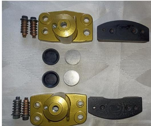
*Nota.* En la figura se observa el despiece de la mordaza de frenos optimizadas con cilindros y sellos nuevos.
