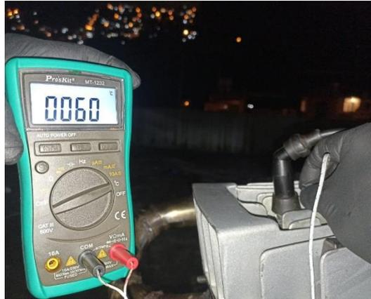
*Nota.* En la figura se observa la medición de temperatura en la culata transcurridos 10 minutos desde el primer encendido.
