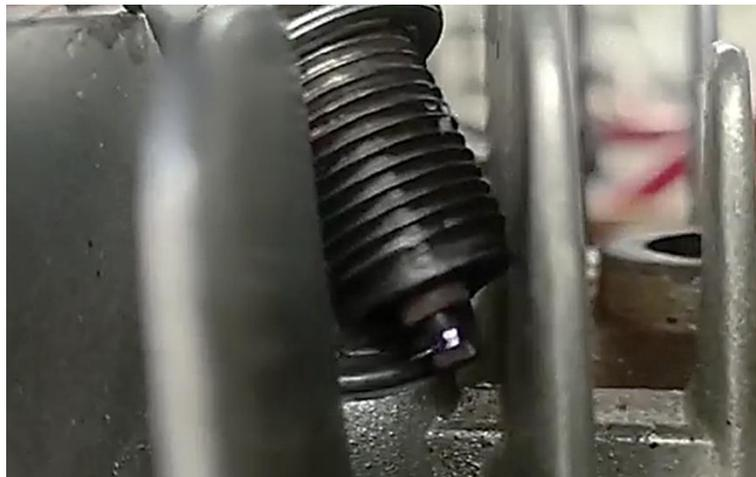
*Nota.* En la figura se observa el arco eléctrico generado entre los electrodos de la bujía.
