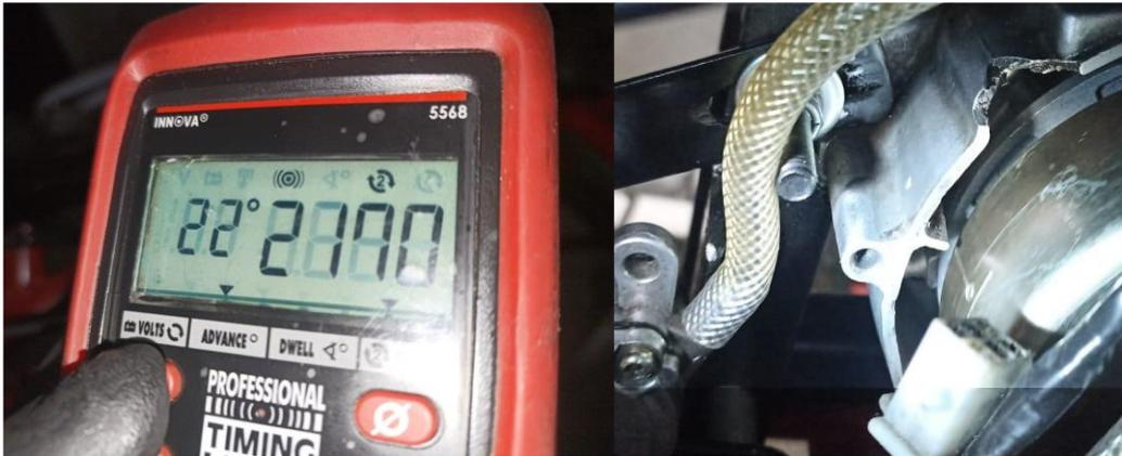
*Nota.* En la figura se observa la verificación del avance al encendido donde en la parte izquierda se visualiza el ajuste de la lampar a 22° de avance y al lado derecho la coincidencia de la marca en el volante con la señal en la carcasa del motor.
