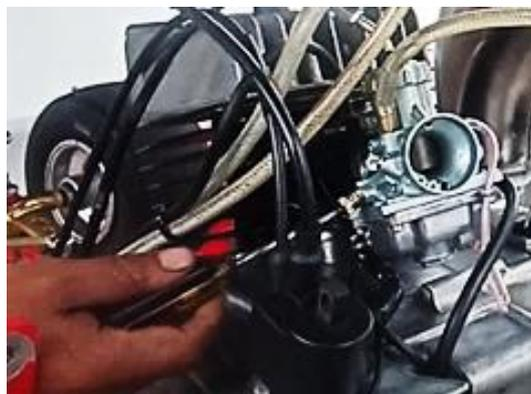
*Nota.* En la figura se observa la posición y ajuste del tornillo de ralentí
