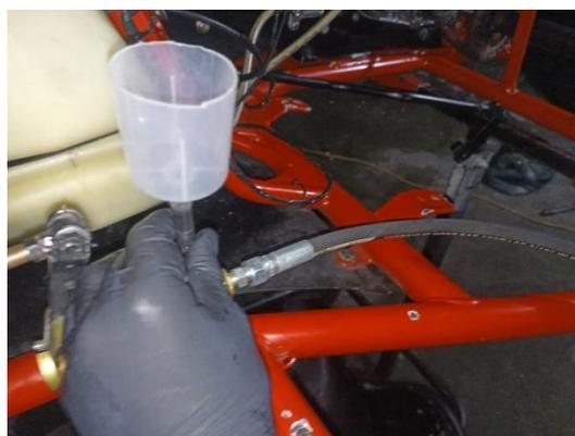
*Nota.* En la figura se observa la purga del sistema de frenos con el implemento requerido.
