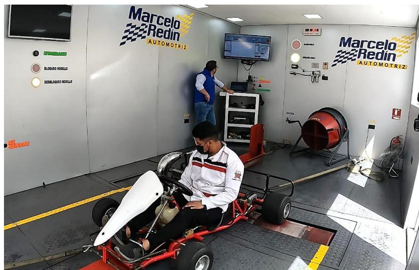
*Nota.* En la figura se observa la ejecución de la prueba dinamométrica.
