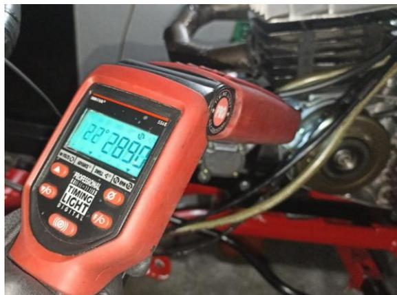
*Nota.* En la figura se observa la medición de régimen de motor cabe donde al régimen medido se debe dividir entre dos ya que este sistema de encendido da dos chispas cada 360° de giro del cigüeñal.
