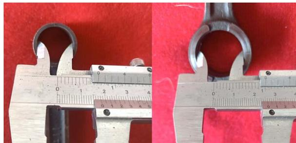
*Nota.* En la figura se observan las imágenes de la medición de los diámetros internos de la cabeza y pie de biela del motor de estudio.
