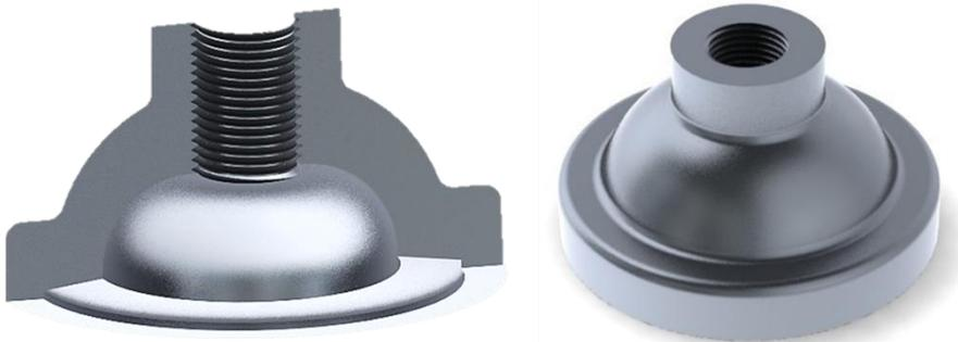
*Nota.* En la figura se observa el modelado 3D del culatín con cámara de combustión tipo aplastamiento, con las dimensiones requeridas para ser insertada en la culata.
