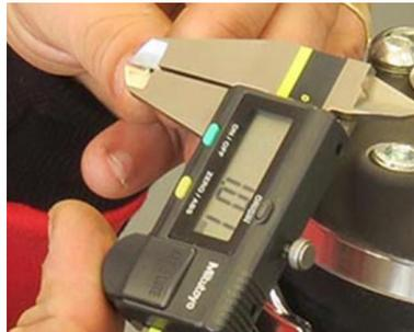
*Nota.* En la imagen se observa la comprobación del espesor del estaño para la verificación del aplastamiento. Tomado de (TKART, 2022).
