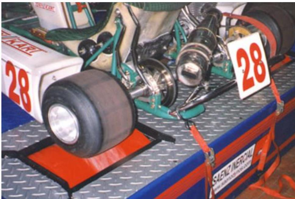
*Nota.* En la imagen se observa un go kart de competencia anclado a un banco de rodillos inercial previo a realizarse la medición de torque y potencia. Tomado de (Saenz Dynos, 2016).
