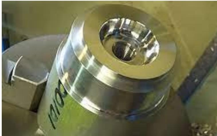
*Nota.* En la imagen se aprecia el material de inicio duraluminio siendo mecanizado a un culatín tipo “Squish” tipo inserto. Tomado de (Ciclomotores Argentinos, 2012).
