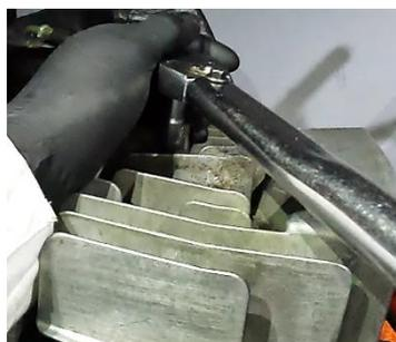
*Nota. En la figura se observa el ajuste de la culata con el torque especificado por el fabricante*
