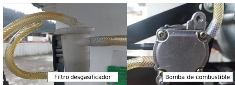
*Nota.* En la figura se observa los componentes principales del nuevo sistema de alimentación.
