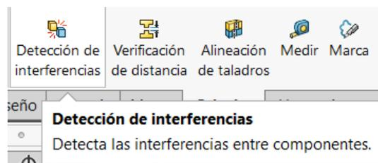
*Nota.* En la figura se observa el botón para determinar si existe interferencias entre los componentes del ensamble.
