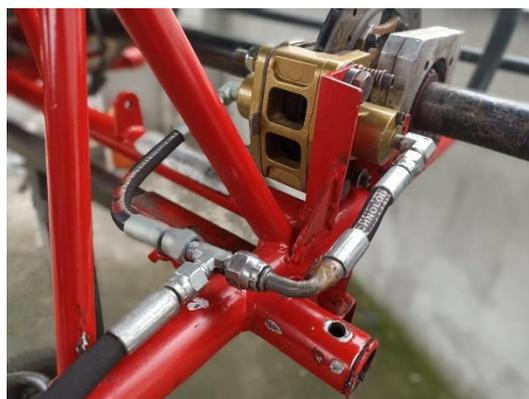
*Nota.* En la figura se observa las líneas de frenos manufacturadas para el prototipo.
