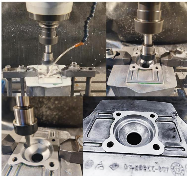
*Nota.* En la figura se observa una compilación del proceso de mecanizado de la cavidad para el inserto tipo culatín.
