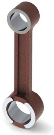
*Nota.* En la figura se observa el modelado 3D de la biela del motor Suzuki AX 100.
