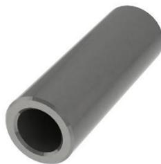
*Nota.* En la figura se observa el modelado 3D del bulón del pistón del motor Suzuki AX100.
