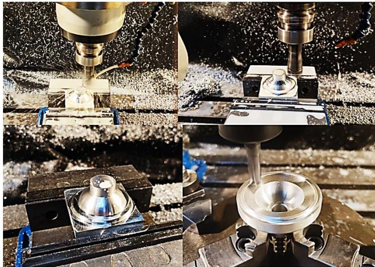
*Nota.* En la figura se observa una compilación del mecanizado CNC del culatín tipo inserto.
