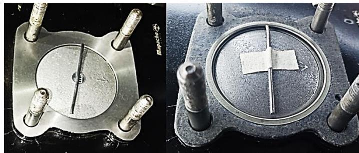
*Nota. En la imagen se observa la colocación del estaño para medir el aplastamiento en el motor modificado.*
