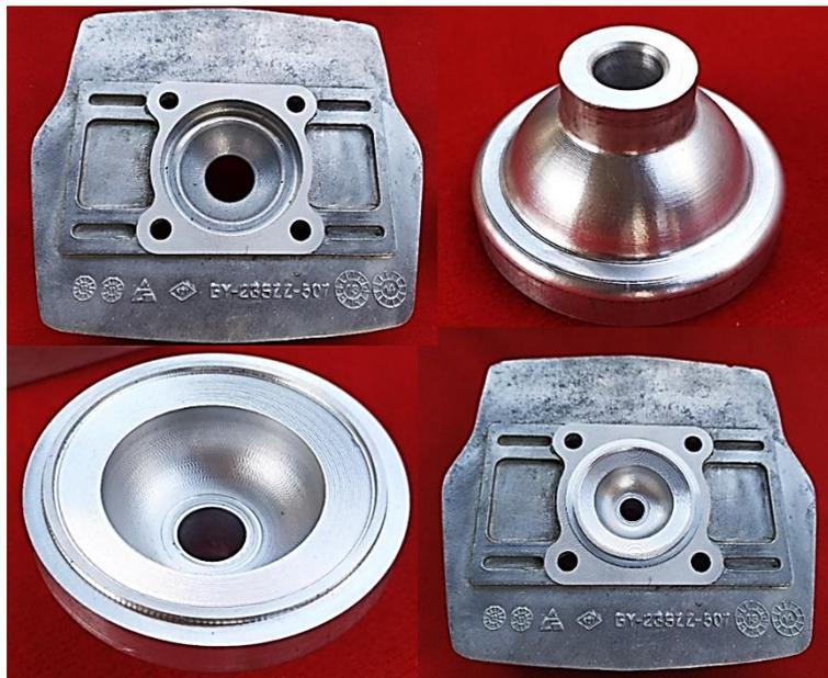
*Nota.* En la imagen se observa las piezas finales luego del mecanizado CNC.
