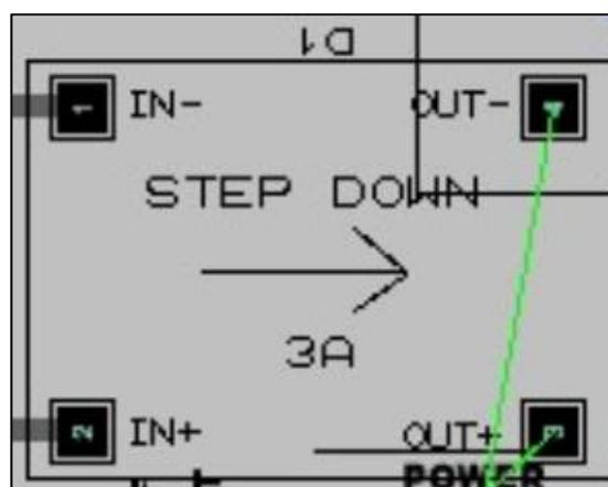
*Nota.* Ubicación del regulador de voltaje en la placa con las entradas y salidas de voltaje.
