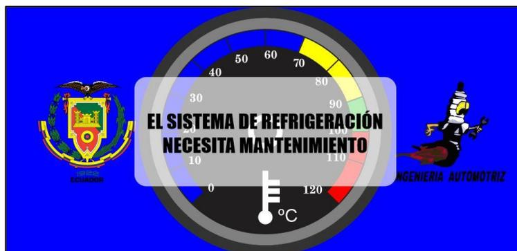
**Rango de 100 - 120 °C por más de 60 segundos.** Cuando entra a la zona de alerta de sobrecalentamiento aparece en pantalla la alerta de para el motor con el objetivo de ya no seguir manejando puesto que esto daría como resultado daños costosos para el conductor. De igual manera se conservaría el fondo de color rojo como se aprecia en la Figura 41.
