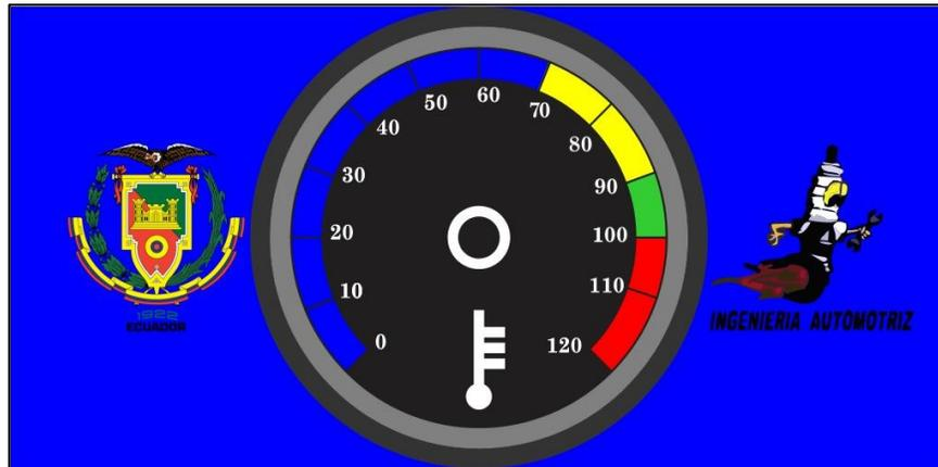
**Rango de 70 - 89°C.** Después que el vehículo esté encendido y se encuentre dentro del este rango de temperatura normal, variará el fondo en la pantalla, como se muestra en la figura 37. Este color indica que el vehículo está cerca del rango de operación, para que se muestre en pantalla se tiene que diseñar con todos los objetos en el mismo lugar para que tenga en efecto de cambio de pantalla.
