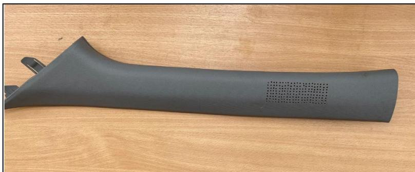
*Nota.* Perforación de la salida de audio en el parante izquierdo del vehículo.
