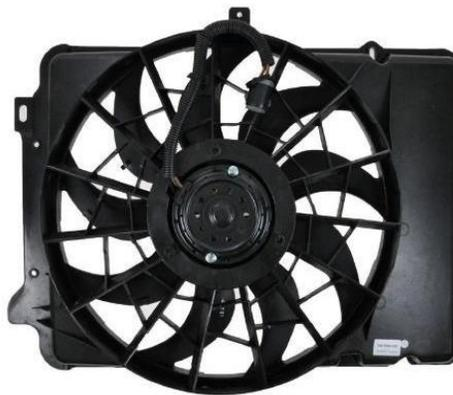
*Nota.* El electroventilador se activa para tener una temperatura adecuada del motor. Tomado de (MAHLE Argentina S.A., 2001)
