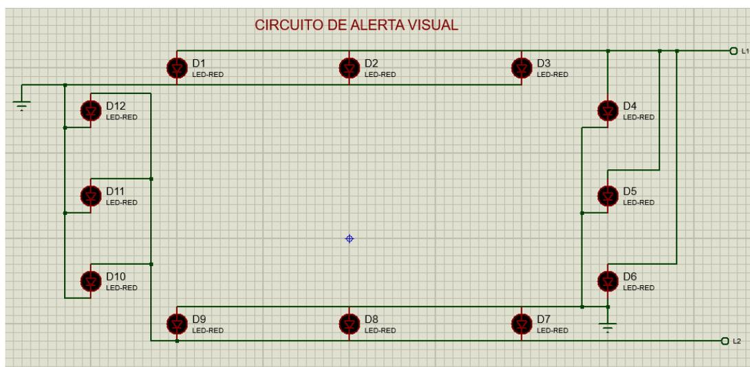
*Nota.* Diagrama de conexión de luces led Rojo para el marco de la pantalla.
