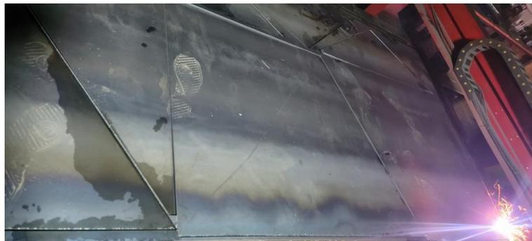
Una vez cortado el material procedemos a perforar agujeros que sostendrán los rieles por donde se deslizará tanto el eje X e Y, después procedemos a soldar la base para formar la estructura como se puede ver en la Figura 36 y 37.
