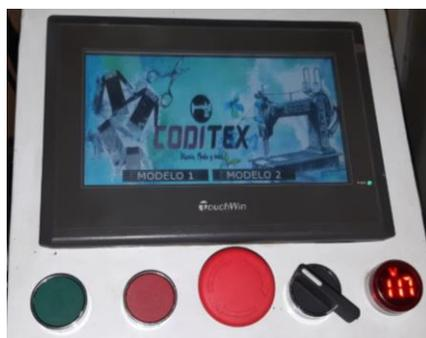
El HMI cuenta con pantallas bajo la norma ASM, la cual nos proporciona directrices para obtener un espacio de interacción eficaz y coherente de máquina-humano y aumentar al máximo el potencial humano con visualización de información exacta de la máquina, operaciones y errores producidos por la misma. La norma se encuentra en el Anexo 6.
