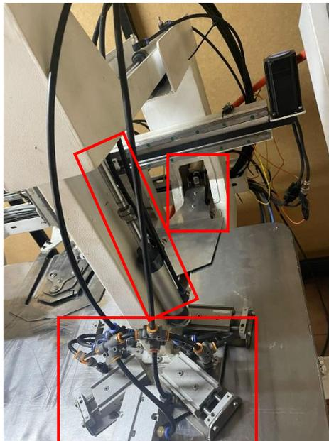
Finalmente se colocan los pistones de doble efecto en la zona de costura que consta de 4 pistones los cuales están distribuidos de la siguiente forma; 2 pistones para sujetar la trasera del pantalón, 1 pistón que sujeta el bolsillo y 1 pistón que permite expandir y contraer la zona de costura del bolsillo como se puede ver en la Figura 45.
