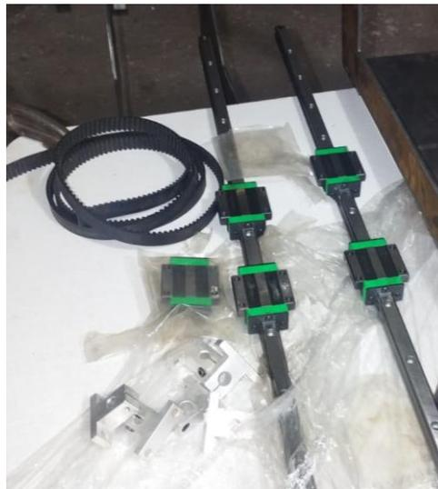
*Nota.* La figura muestra el riel seleccionado para el movimiento de ejes.
