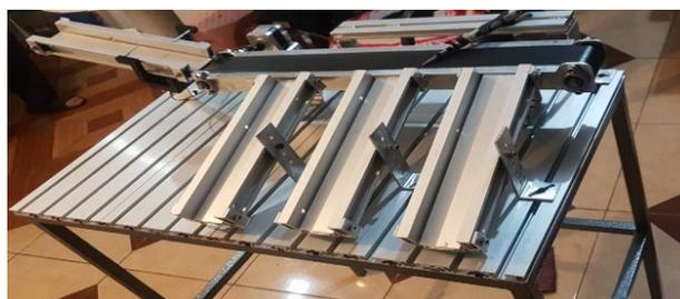
Donde como ya se mencionó para los actuadores y el dispensador, se los construyó armándolos con PLA de color negro, una vez diseñados e impresos mediante impresión 3D y unidos mediante pernos M3.
