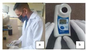
Nota. a) Colocación de muestra en el refractómetro y b) Lectura de °Brix.
