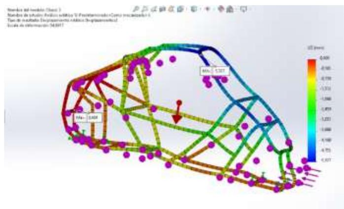
*Nota.* En la figura 80, es calcula la deformación máxima longitudinal.
