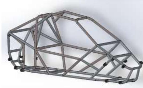
*Nota.* En la figura 58, son identificados los puntos de sujeción en los cuales se coloca la suspensión tanto delantera como trasera en el modelo seleccionado.
