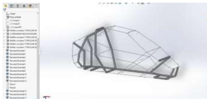
*Nota.* En la figura 60, se evidencia como se coloca el tubo sobre el croquis en 3D que se ha dibujado en el software CAD.
