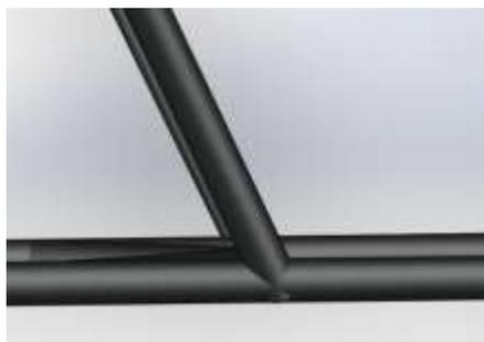
*Nota.* En la figura 62, como se muestra al momento de soldada de tubos en el software CAD existe interferencias en a uniones que deben ser corregidas.
