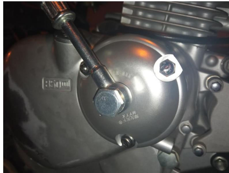
2. Desmontar tapa del filtro de aceite e instalar la nueva
