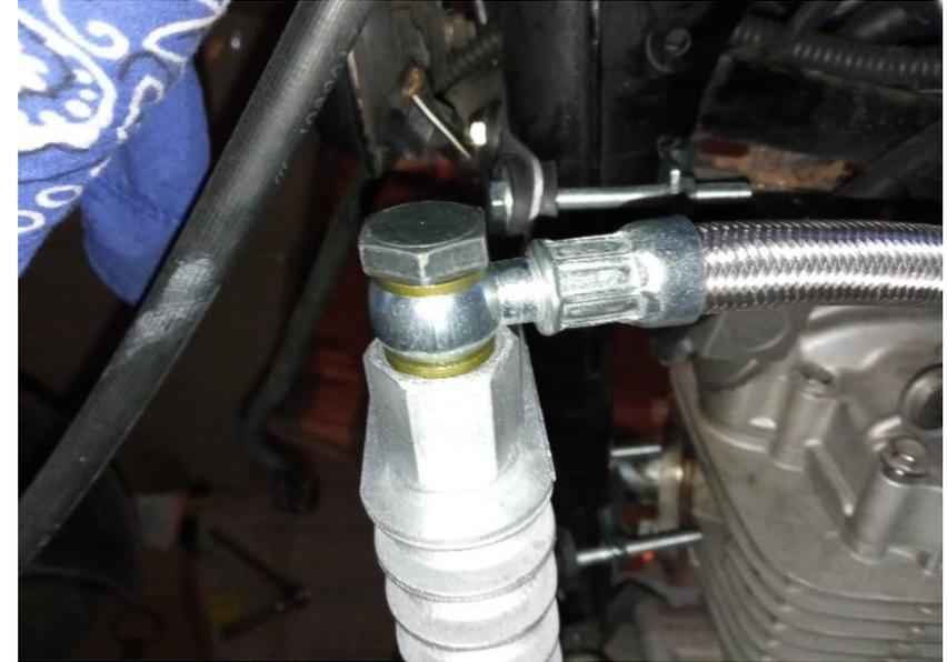
6. Se conecta la segunda manguera hidráulica del radiador al motor
