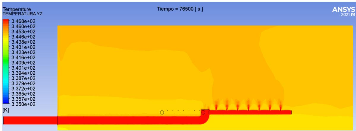
En la figura 77 se observa que la distribución de temperatura utilizando el difusor radial es mucho más uniforme que en los casos B1 Y B2. Esta mejor distribución de temperatura se da gracias a la presencia de los agujeros del difusor por donde ingresa el crudo al tanque de almacenamiento.
