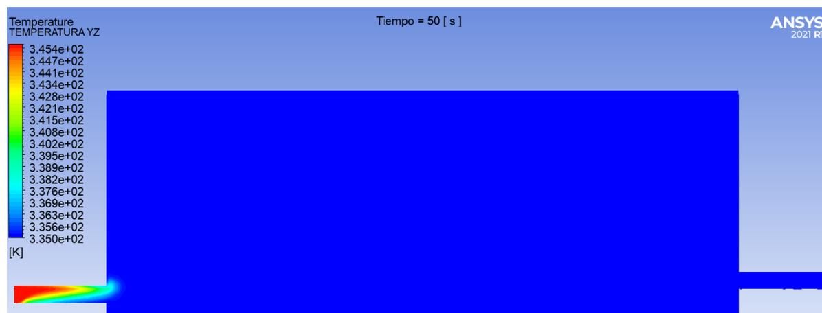
Para el caso B1 la distribución de temperatura que se tiene al inicio es la que se presenta en la figura 62, en donde se observa que la temperatura promedio del tanque al iniciar la simulación es de 335 [K] y el crudo luego de pasar por el intercambiador de calor tiene una temperatura de 345 [K] como se puede observar en la entrada del tanque de almacenamiento.
