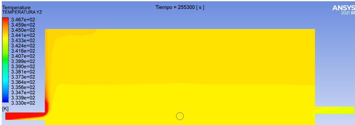
En la figura 71 se observa la distribución de temperatura que tiene el crudo luego de 260000 [s] o 3 [días] desde que se inicio el proceso de calentamiento, así como también se puede observar la diferencia de temperatura que tiene el crudo entre la entrada del tanque y la temperatura promedio que tiene en el resto del tanque.
