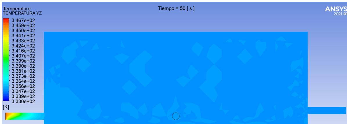
Con el calentamiento caso B2 se tiene como finalidad verificar si el ingreso de crudo por dos ubicaciones distintas al tanque de almacenamiento permite reducir el tiempo de calentamiento del crudo en relación con el caso B1. En la figura 67 se observa la distribución de temperatura del crudo dentro del tanque de almacenamiento.
