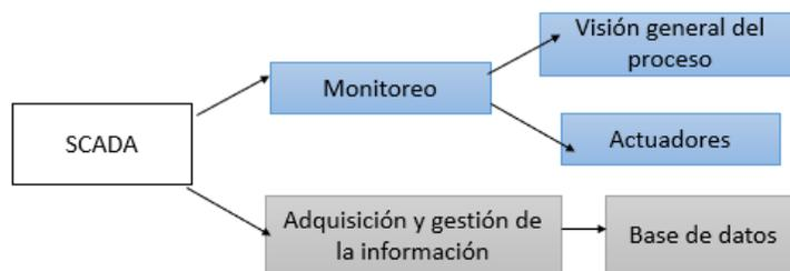
*Nota.* Para el diseño del SCADA se consideró el monitoreo del proceso y la adquisición de datos de las variables más relevantes del proceso
