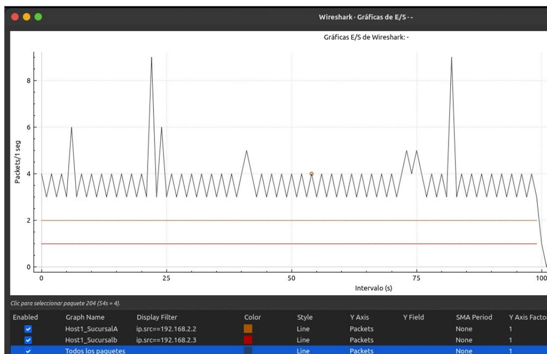
Fig. 49. Grafica de paquetes en Wireshark para la topología VXLAN
