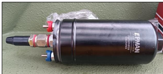
Bomba de combustible externa
