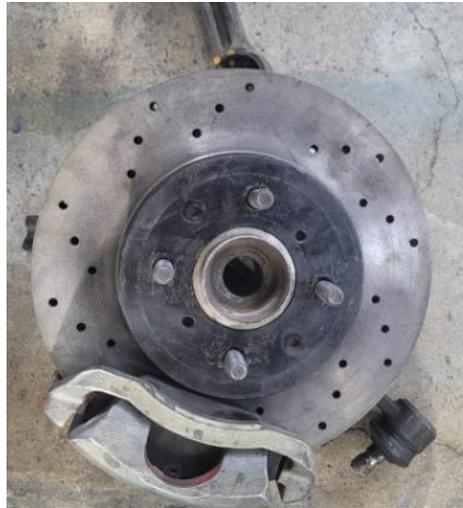
*Nota.* Discos de freno perforados para las ruedas traseras del vehículo.
