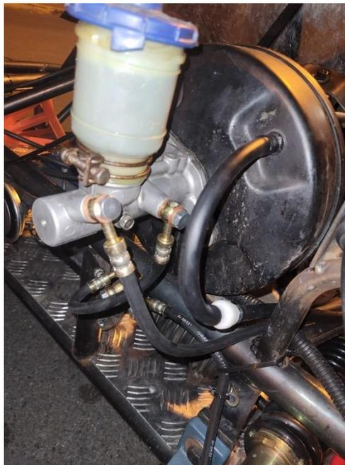
*Nota.* Mangueras de freno que salen del cilindro maestro del servofreno.
