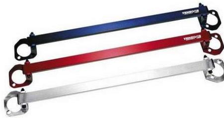
*Nota.* Barra Estabilizadora Superior de automóviles. Tomado de (EspirituRacing, 2024).
