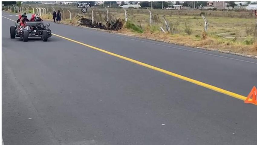
*Nota.* Prueba de distancia de reacción a la velocidad de 50 km/h.
