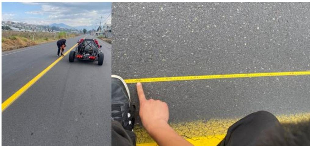
*Nota.* Medición de la distancia de frenado a 50 km/h.
