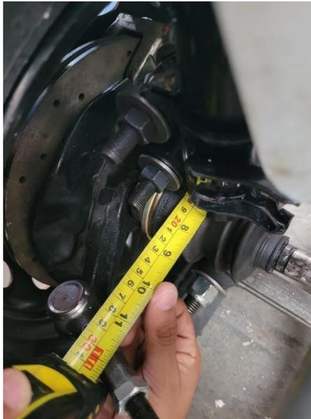
*Nota.* La medida que se tiene de los discos perforados de la parte posterior del vehículo es de 30 cm.
