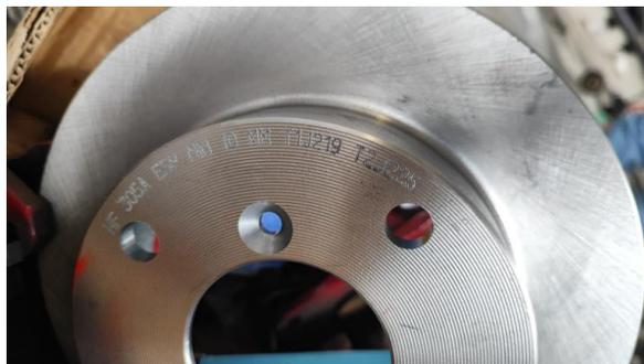
*Nota.* Disco sólido original del Suzuki 1 para las ruedas delanteras 25 cm.
