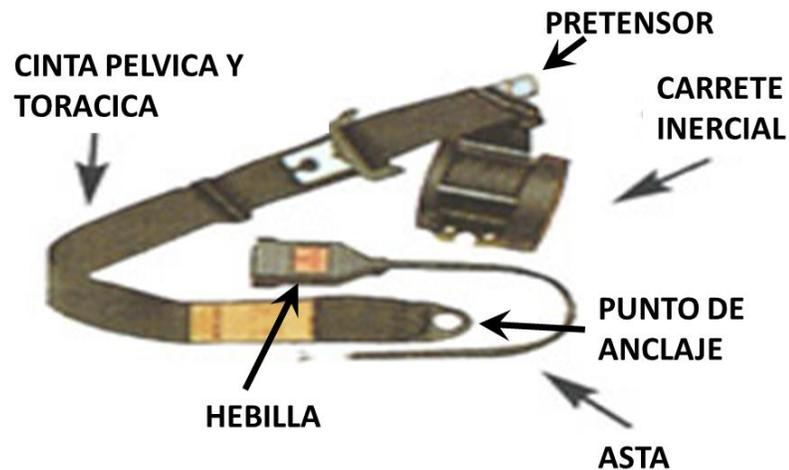
*Nota.* Componentes principales de un cinturón de seguridad. Tomado de (ConsulVial, 2021).
