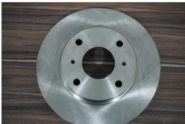
*Nota.* Discos de frenos macizos para Suzuki Forsa 1. Tomado de (GF Automotriz, 2024).
