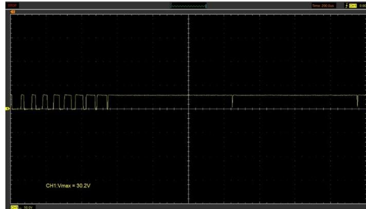
En la figura 42, se observa en las señales anteriores, se encuentran a un voltaje máximo de 35.3V para la bobina 1, 35.1V para la bobina 2 y 35V para la bobina 3. En la tercera marcha con una aceleración mínima que llega a cada uno de las bobinas ya que estos pueden estar conectados en estrella o triángulo, y sus periodos se encuentran en el mismo rango establecido de 50 us.
