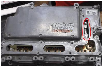
Fusible que protege de la calefacción
