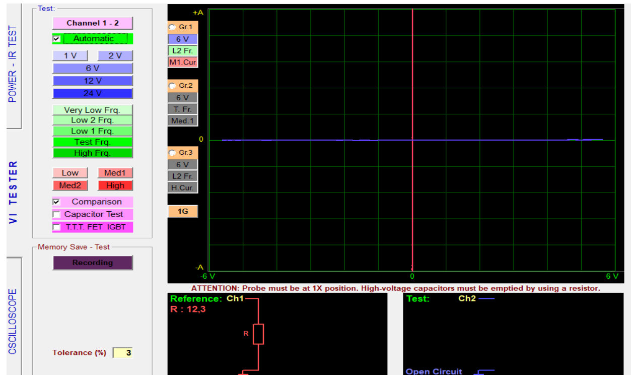
Gráfica de Lissajous del reactor del Toyota Prius
