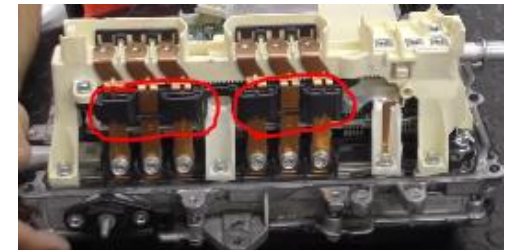
Pinzas amperimétricas - fases que tiene los motores
