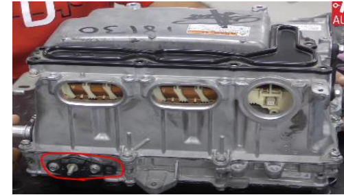
Pin para la batería de 12 voltios al inversor.
