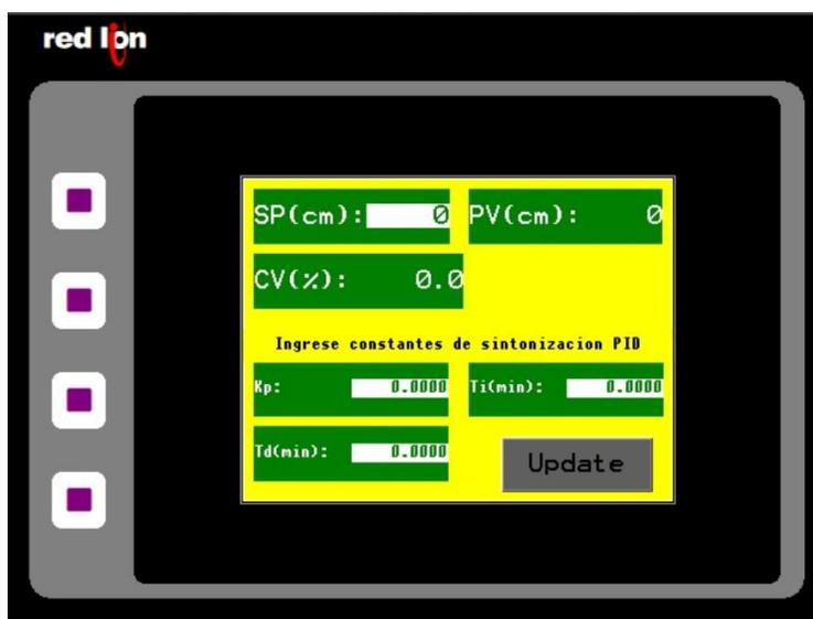
*Nota.* Tomado de Crimson 2.0, se muestra la visualización de las variables SP, PV, CV y el ingreso de las constantes del controlador.
