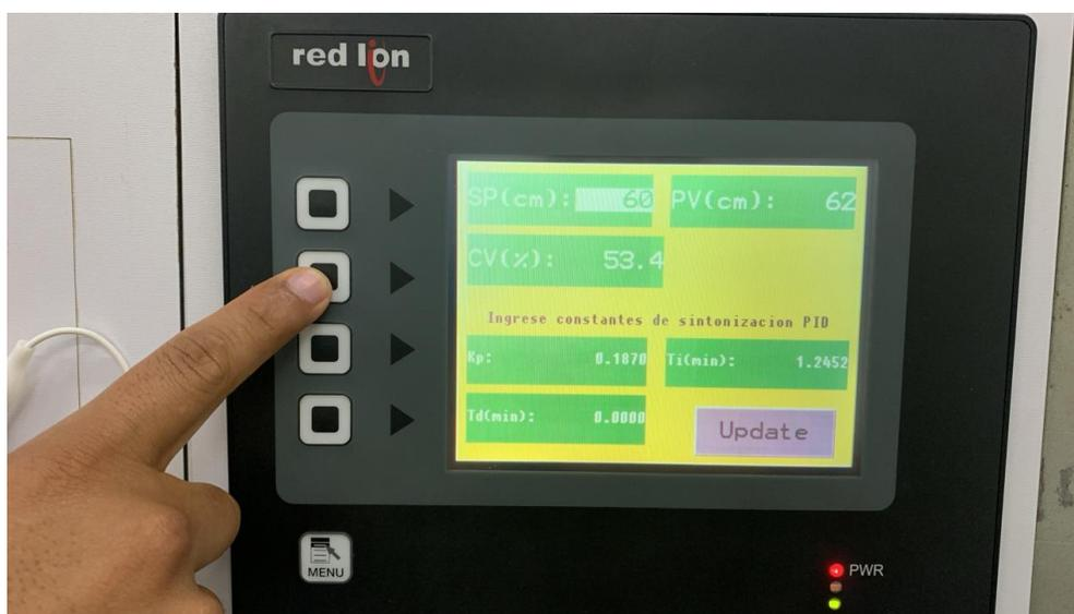
*Nota.* Se muestra la pantalla para el ingreso de las constantes de sintonía mediante una HMI local y visualización del SP, PV y CV.
