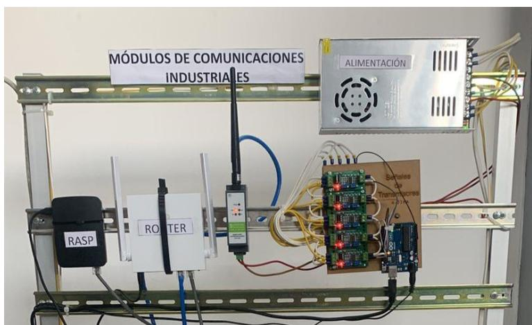
*Nota.* Se muestra la conexión del módulo de comunicaciones industriales
