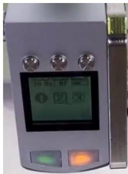
En la figura 27 se visualiza el sensor que guardo un color en la variable número uno, eso se puede confirmar observando en la pantalla el número 1 encerrado por un círculo de color negro y por la lampara de color tomate que esta prendida.
