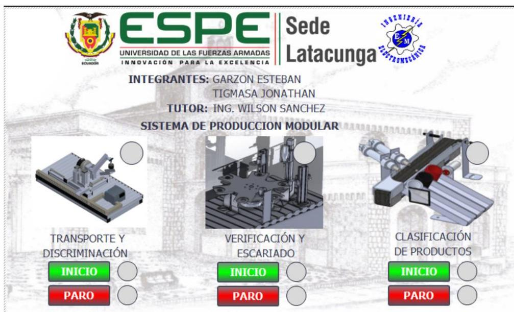
*Nota.* La figura muestra el HMI diseñado para el control y monitoreo de los procesos del sistema de producción modular.
