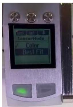
En la figura 25 se observa la selección de dicho modo en el sensor, el sensor cuenta con tres botones los cuales ayudan para navegar por los ajustes del sensor además que cuenta con una pequeña pantalla lo que facilita la configuración del sensor de color.
