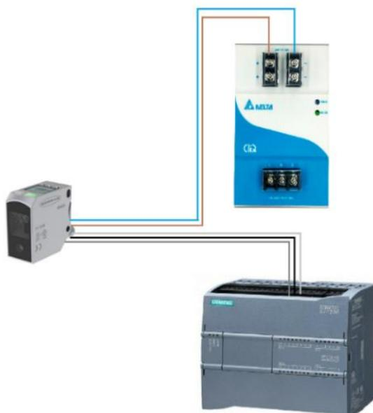
Una vez realizada la correcta instalación del sensor al PLC, se debe grabar los colores de productos a clasificar, entonces se selecciona el modo de “Best fit” en el sensor, este modo es el indicado para aplicaciones en donde se requiera clasificar productos en función de su color.
