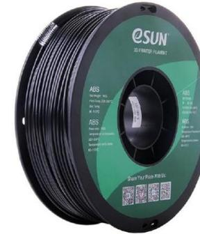
*Nota.* Filamento con 29 kJ/m<sup>2</sup> de resistencia al impacto, 22% de elongación a la ruptura y con resistencia a la tracción de 43MPa, resistencia a la flexión de 66MPa y con módulo de flexión de 1177MPa, requiere temperaturas de 230 a 270°C y la cama de 95 a 110°C.
