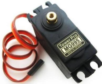
*Nota.* Servomotor normalmente empleado para domótica y apartados electrónicos. Tomado de (Novatronic, 2023).
