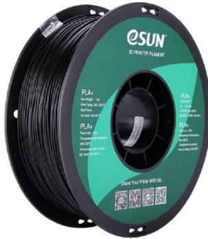
*Nota.* Filamento con 9 kJ/m<sup>2</sup> de resistencia al impacto, 20% de elongación a la ruptura y con resistencia a la tracción de 63MPa, resistencia a la flexión de 74MPa y con módulo de flexión de 1913MPa, requiere temperaturas de 210 a 230°C y la cama de 45 a 60°C.
