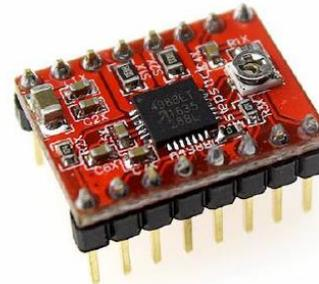
Nota. Driver con capacidad máxima de 2 amperios para motores paso a paso. Tomado de (AV Electronics, 2023).
