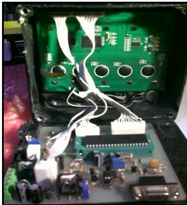
Figura 5.15: Instalación del módulo maestro con la pantalla GLCD
