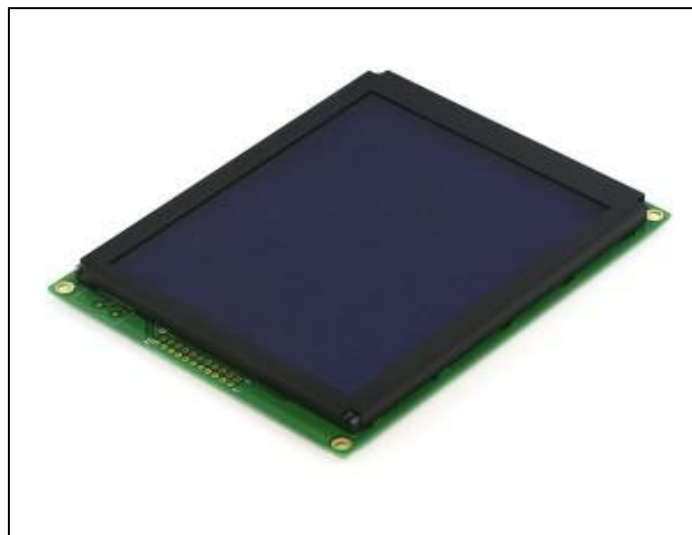
Figura 2.3: Pantalla GLCD 240x128
