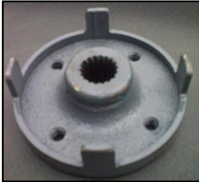
Figura 5.8: Rueda fónica adaptada en la junta del árbol de transmisión
