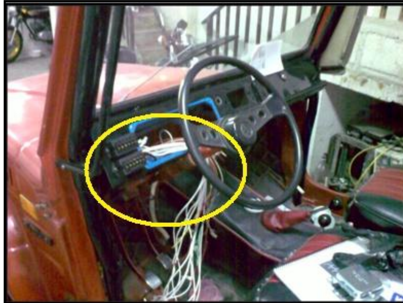
Figura 5.2: Instalación de fusibleras y cableado nuevo
