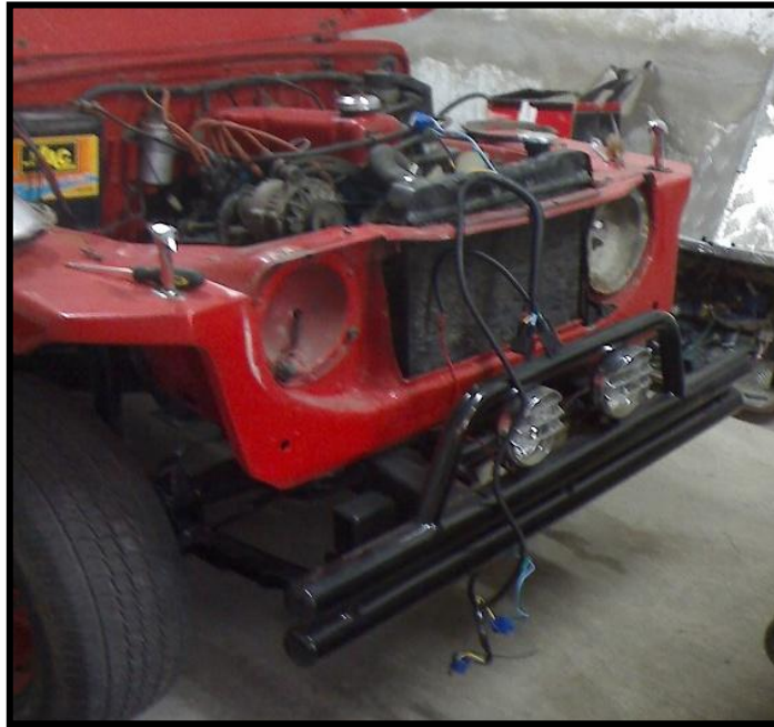
Figura 5.4: Desmontaje de focos silbines
