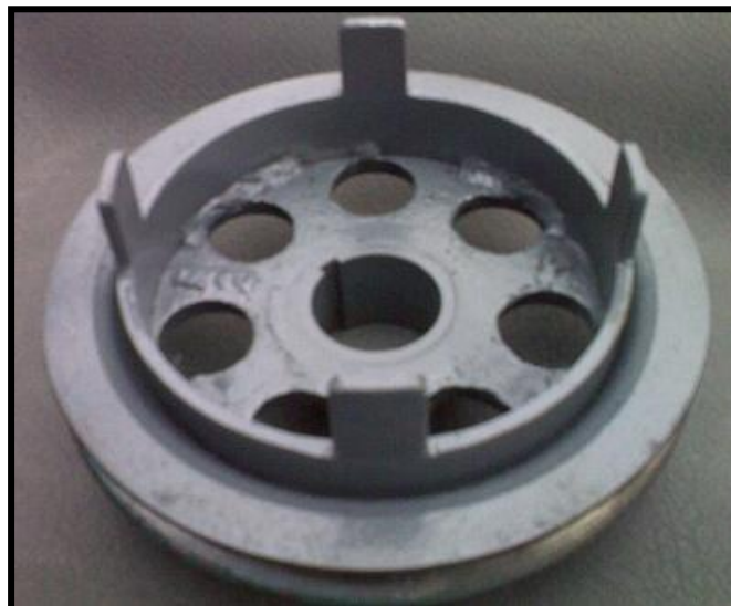
Figura 5.7: Rueda fónica adaptada en la polea del cigüeñal
