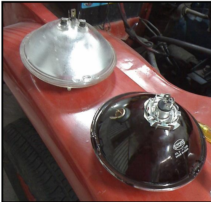
Figura 5.5: Reemplazo focos silbines a faros halógenos
