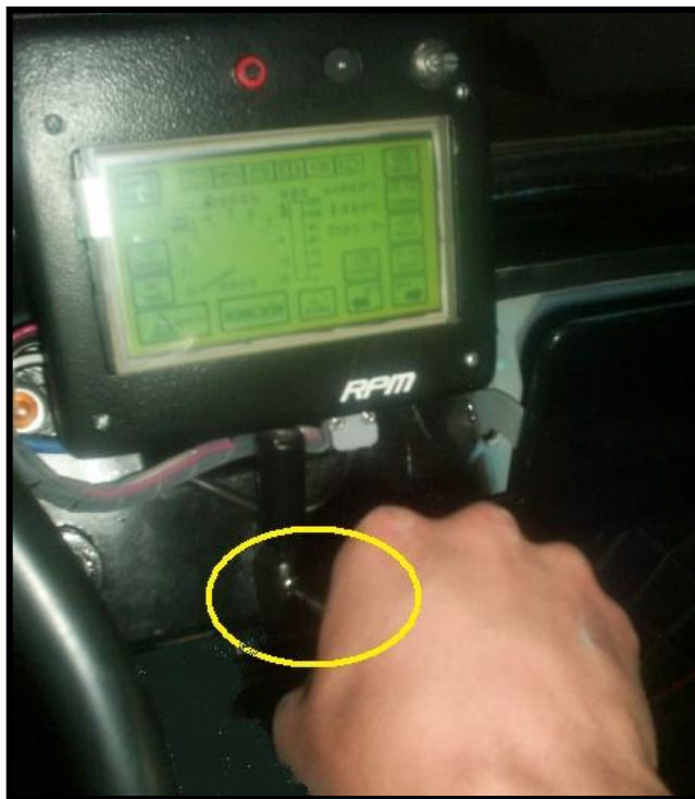
Figura 5.16: Fijación módulo maestro con la pantalla GLCD
