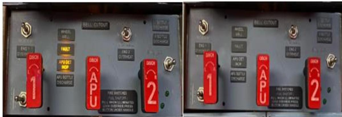
Test operativo del sistema, al colocar el switch de TEST en la posición FAULT/INOP.
