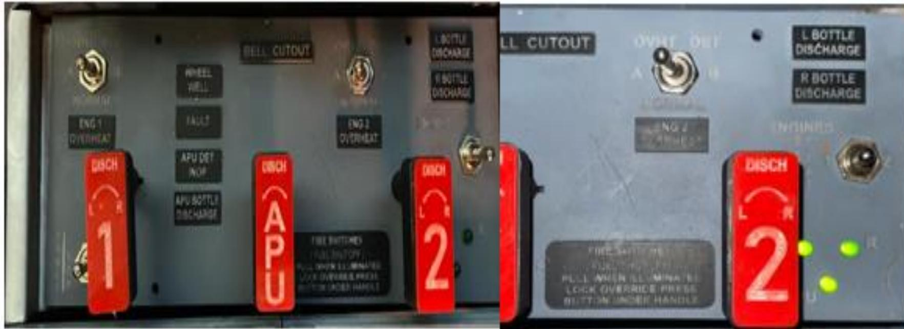
Prueba operativa del switch de Test de extinción del APU y la prueba de luces de las 3 botellas del agente extintor.
