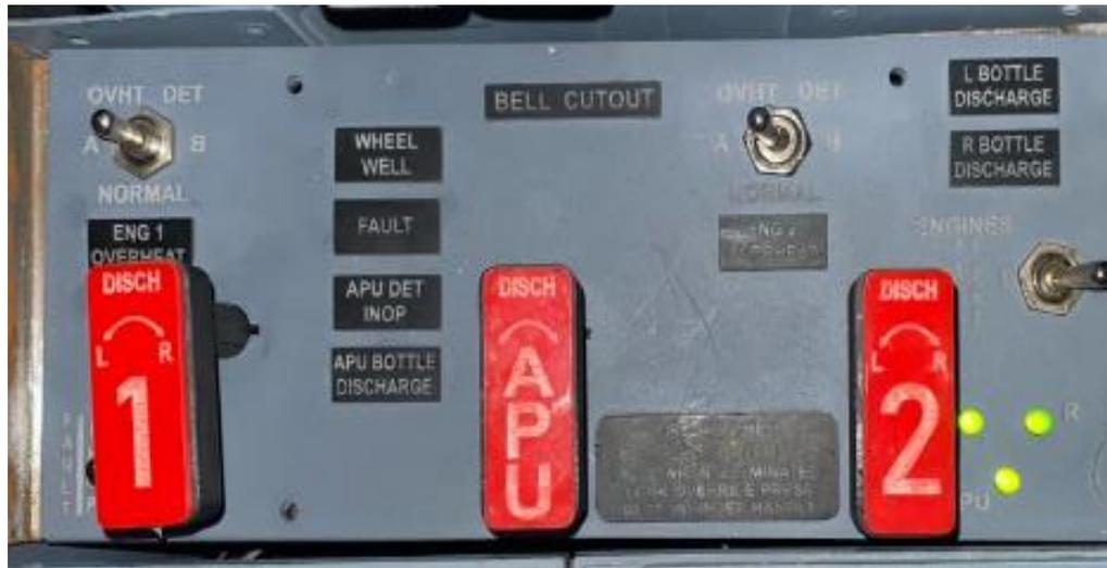
Las luces se encienden al colocar el switch de EXT TEST en la posición 2
