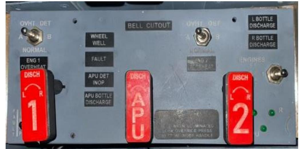
Operación del switch de EXT TEST al regresarlo a su normalidad, nos demuestra que las luces del panel P8-1 se apagan.
