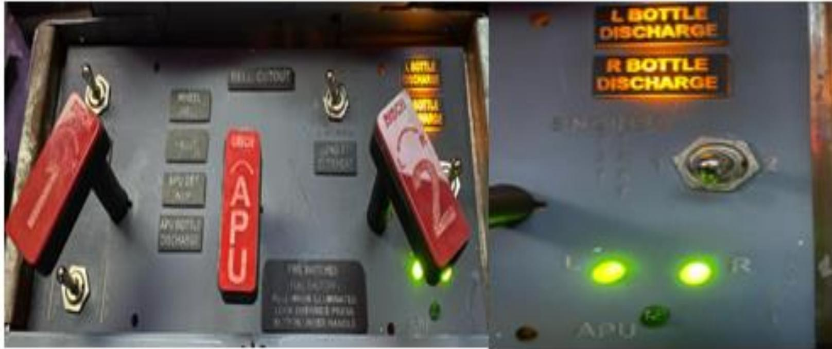
Operación de las luces de descarga de las botellas del agente extintor tanto izquierda como derecha del motor 1 y 2.
