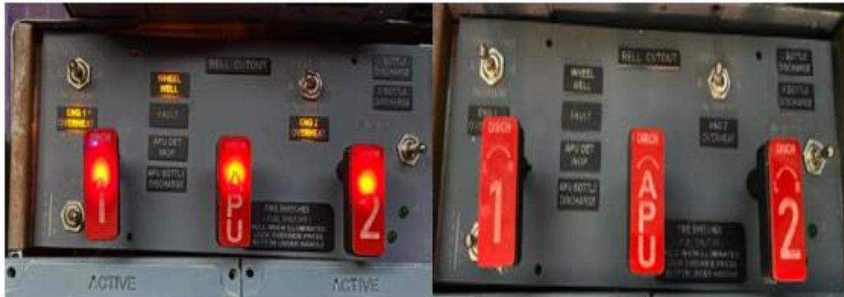
Test operativo del sistema de detección de incendios del motor, al colocar el switch de TEST en la posición OVHT/FIRE.
