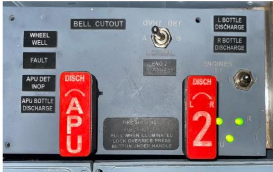
Las luces se encienden al colocar el switch de EXT TEST en la posición 1
