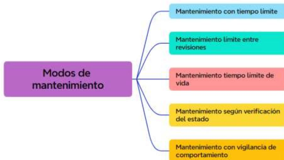
*Nota.* La figura muestra los diferentes modos de mantenimiento.
