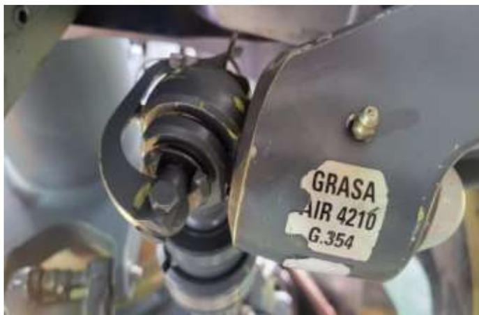
*Nota.* En la figura se muestra la verificación del perno de argolla que se encuentre dentro de las tolerancias.
