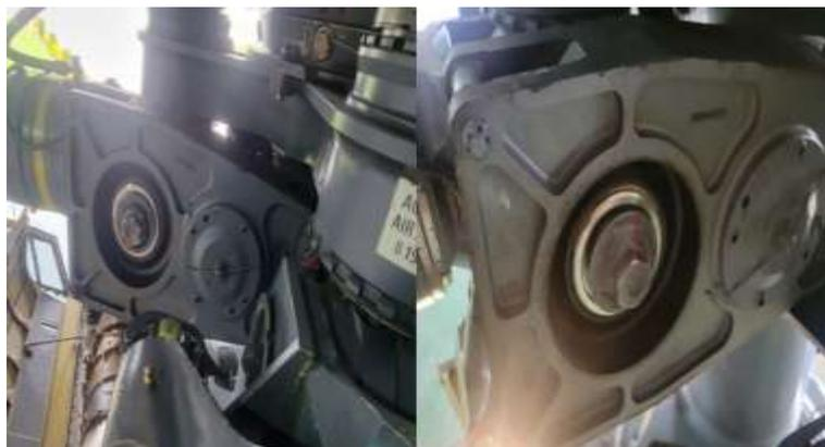
*Nota.* En la figura se muestra la verificación de los adaptadores de frecuencia con el comprobador de juegos y tolerancias en el cual se encuentran dentro de los parámetros establecidos.
