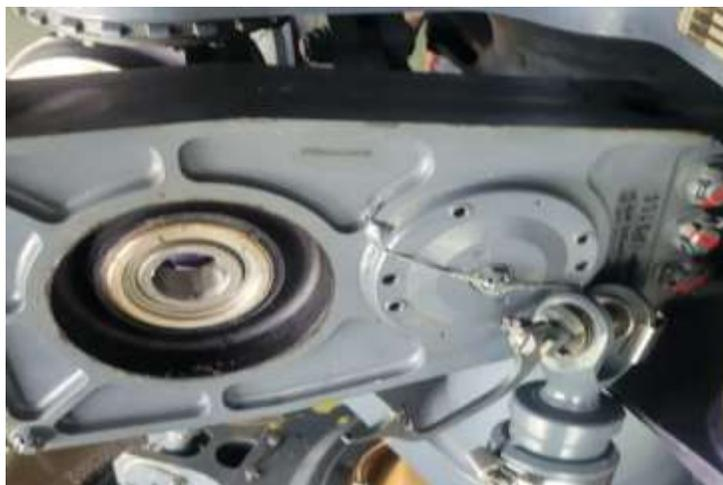
*Nota.* En la figura se muestra el desmontaje del adaptador de frecuencia.
