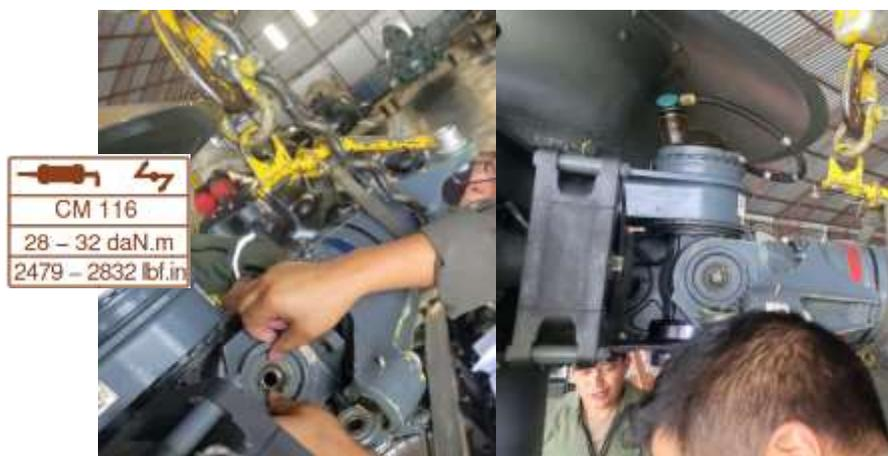
*Nota.* En la figura se muestra la verificación el par de apriete y se dejó en el rango permitido de 2479 a 2832 lbf.in.
