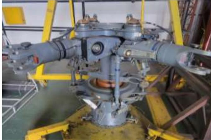
*Nota.* La figura muestra el conjunto rotor cabeza del helicóptero desmontado y instalado en la herramienta especial.
