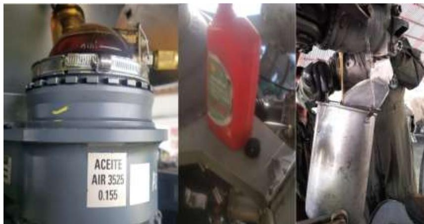
*Nota.* En la figura se muestra el depósito de aceite de las mangas, y procedimiento de drene de aceite.
