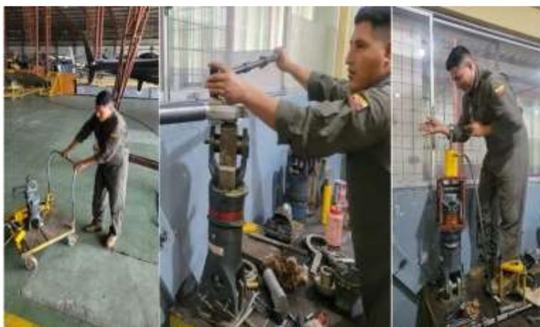
*Nota.* En la figura se muestra el desmontaje del muñón.
