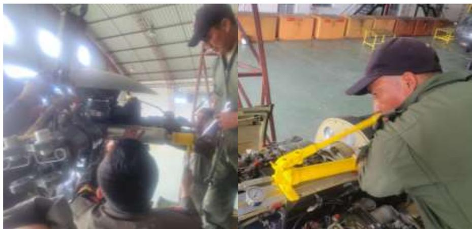
*Nota.* En la figura se muestra el desmontaje conjunto “mangueta-muñón” con ayuda del Jack hidráulico de 10 toneladas y la bomba hidráulica.
