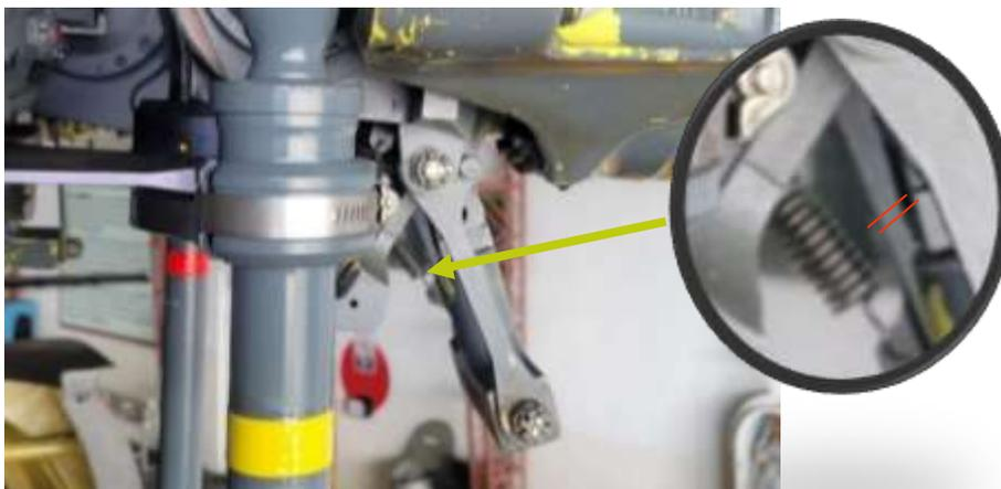
*Nota.* En la figura se muestra la verificación de los topes bajo y la medida de los fuelles encontrándose en la medida de 1mm el cual está en buenas condiciones.
