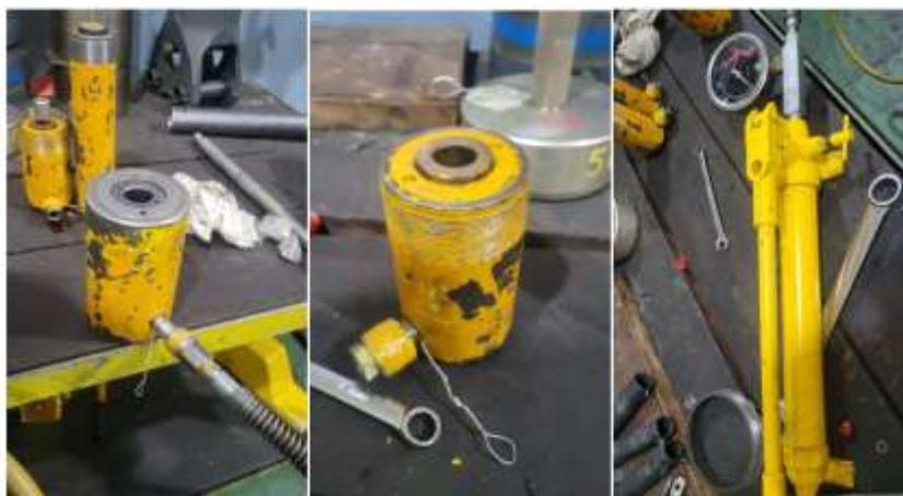
*Nota.* En la figura se muestra las herramientas en mal estado, fuga de aceite de las gatas hidráulicas y de la bomba hidráulica.
