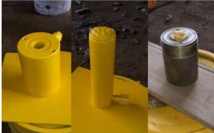
*Nota.* En la figura se muestra el proceso de pintura y decapado que se le dio a los cilindros hidráulicos y la bomba hidráulica.
