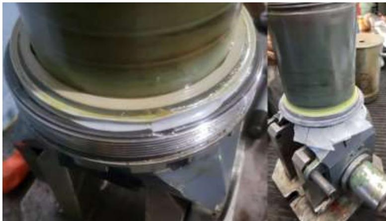
*Nota.* En la figura se muestra la sustitución de las juntas de estanqueidad de la mangueta.
