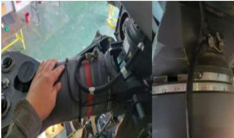
*Nota.* En la figura se muestra la verificación del cable de masa, el sector graduado y el correcto frenado del vernier.
