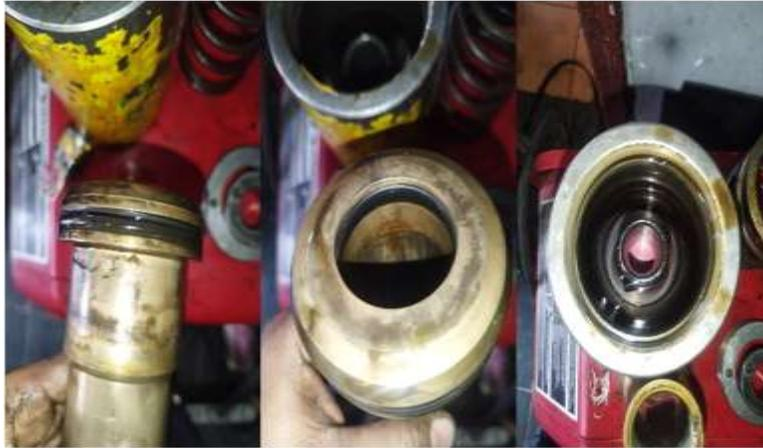
*Nota.* En la figura se muestra que se realizó el cambio de los sellos de los cilindros.
