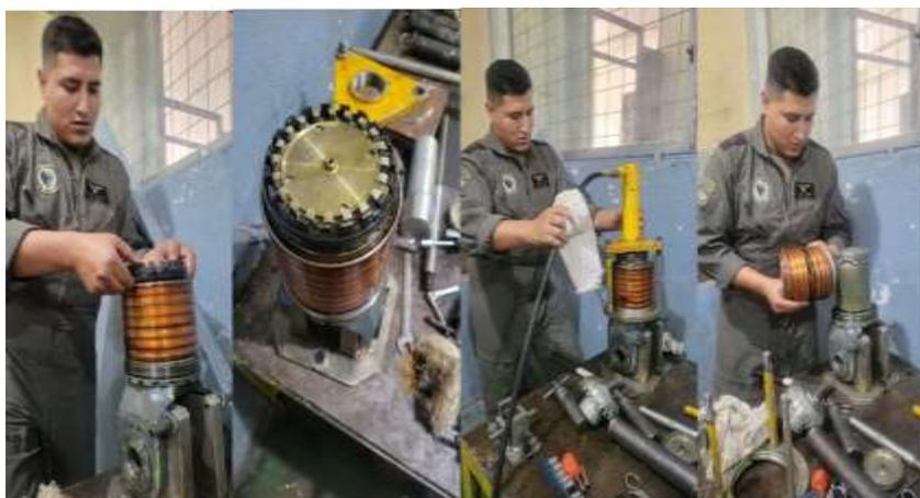
*Nota.* En la figura se muestra el desmontaje de los cojites.
