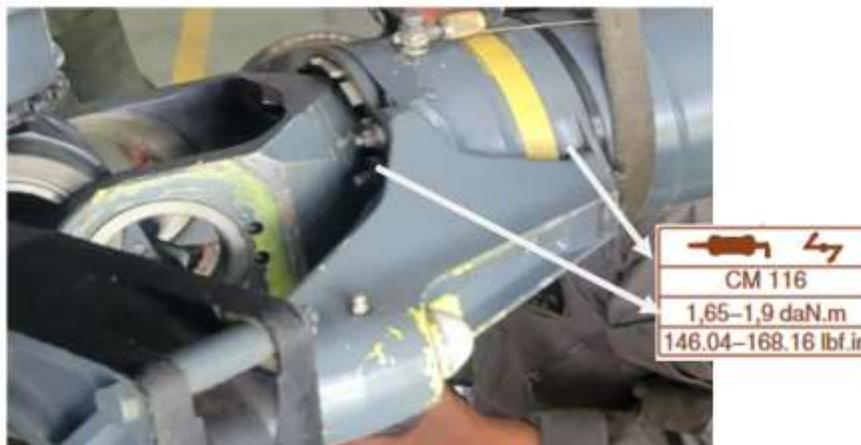
*Nota.* En la figura se muestra la verificación el par de apriete se encuentra dentro del rango aceptable.
