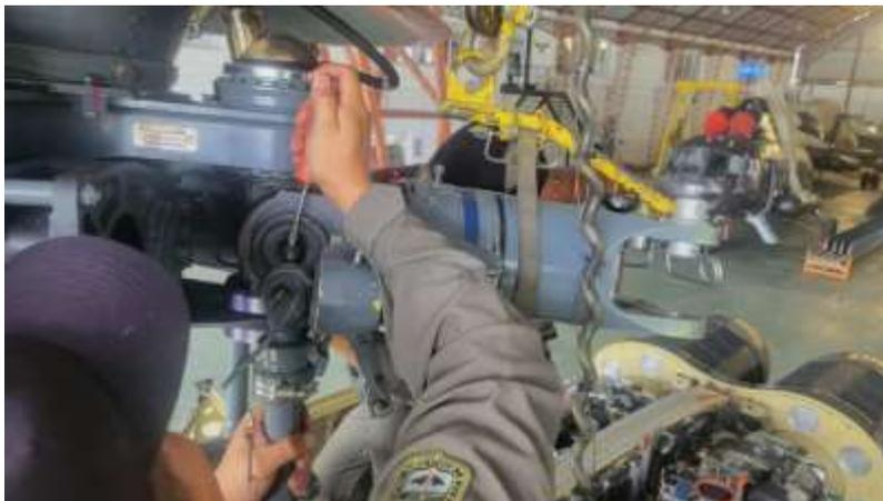
*Nota.* La figura muestra cómo se procede a desmontar la bieleta de mando y del perno argolla.
