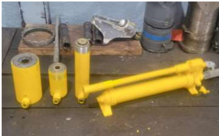
*Nota.* En la figura se muestra las gatas hidráulicas y la bomba hidráulica que se entregó a la sección Super Puma del Grupo Aéreo 45 "PICHINCHA"
