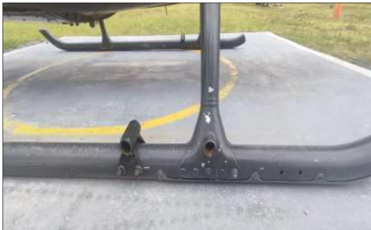
El tren de aterrizaje consta de dos conjuntos de patines simétricos, cada uno de los cuales consta de un patín tubular de aleación ligera y dos patas de acero fijadas a la parte inferior del helicóptero. El tren de aterrizaje trasero está equipado con dos amortiguadores hidráulicos.
