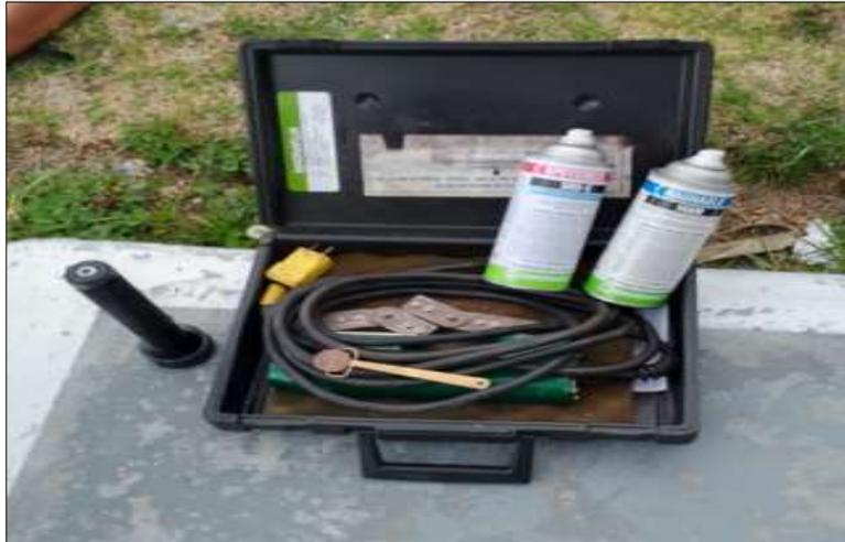
Para efectuar el ensayo por partículas magnéticas se procedió a tapar el área con plástico, esto permitió que se pueda observar el resultado del procedimiento.
