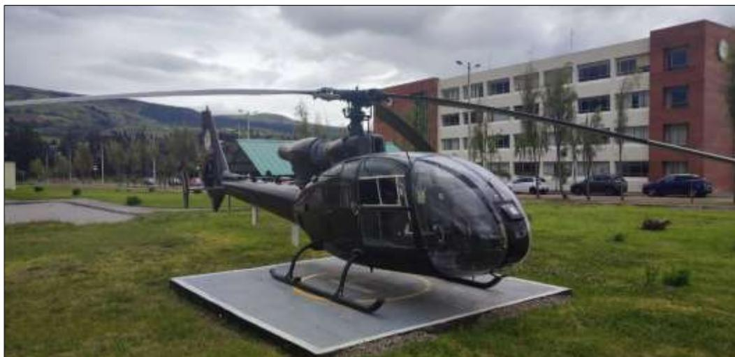
La velocidad crucero máxima de esta aeronave es de 120 nudos, con un techo máximo de 20 pies de altura, con tiempo de vuelo de 2 horas y 30 minutos y una tolerancia de 30 minutos de combustible.
