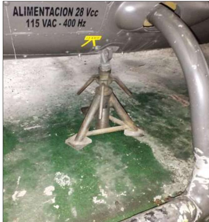
Se procedió a levantar la aeronave en gatas de acuerdo al manual de mantenimiento, este proceso permitirá que la inspección se realice de manera menos complicada en la parte de los patines de aterrizaje especialmente en la parte inferior.
