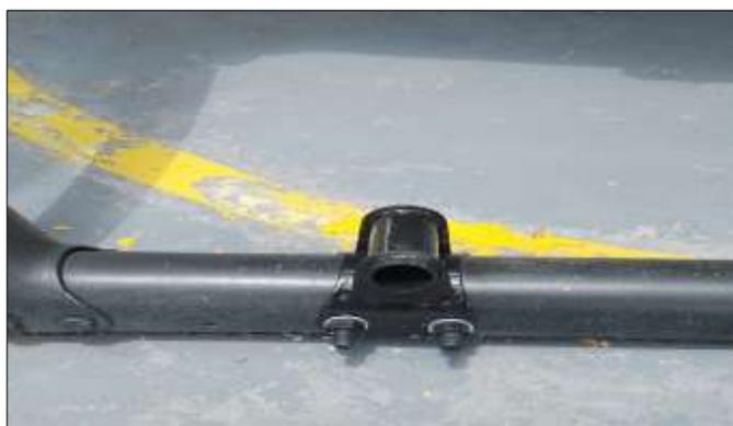
Como se observa en la Figura 57, los herrajes no se encontraban en la aeronave, de tal manera que se procedió a realizar el pedido del componente en bodega, luego se realizó la instalación de los mismos, tal como especifica el manual de mantenimiento. Cabe recalcar que se implemento los dispositivos de izaje y traslado del helicóptero, como muestra la Figura.
