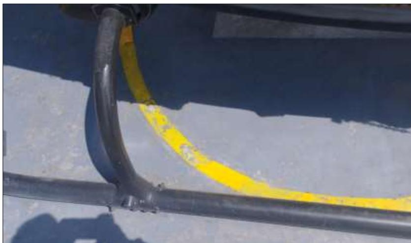
Por último, para la inspección del exterior de los trenes de aterrizaje, se realizó la inspección de las uniones de los tubos del patín de aterrizaje, se determinó que se debe realizar ensayos no destructivos para descartar cualquier anomalía en las uniones de los patines del tren de aterrizaje.
