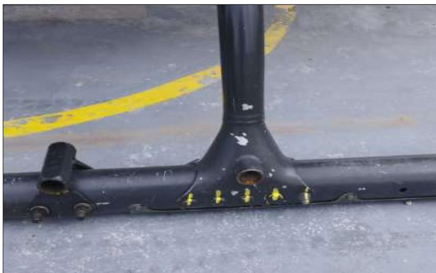
Como se puede observar en la figura anterior, el PRC no se encontraba en los pernos, tuercas, de acuerdo al Manual de Mantenimiento, menciona que debe estar colocado este sellante para evitar que las corrientes de aire aflojen el torque de los mismos, además este sellante cubre las uniones para que no exista presencia de corrosión en los mismos.
