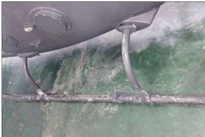
Se procedió a realizar la inspección del SKI del tren de aterrizaje como se muestra en la Figura anterior se puede observar que este se encontraba con desprendimiento de pintura externa, pero sin ningún reportaje mayor, como muescas, rajaduras, etc.
