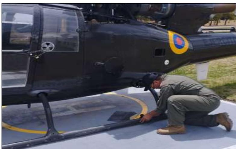
Se efectuó la inspección visual por grietas tal como especifica el manual, en los patines de aterrizaje del helicóptero se realizó una inspección para descartar cualquier tipo de grietas
