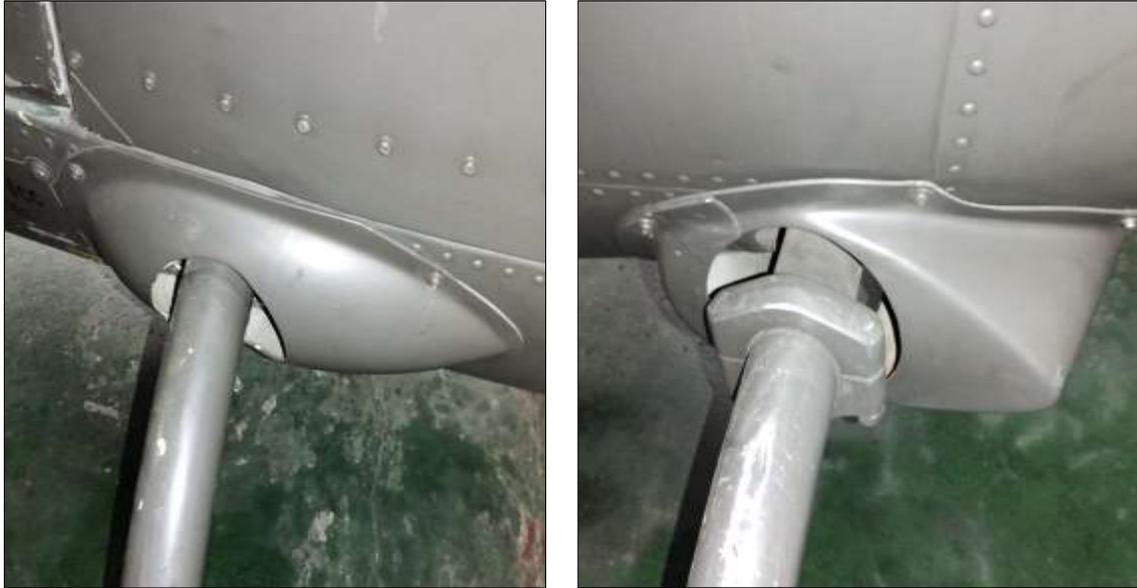
Luego de remover los carenados de los soportes laterales de los trenes, se procedió a relizar la inspección del interior del los carenados, como menciona el manual de mantenimiento.
