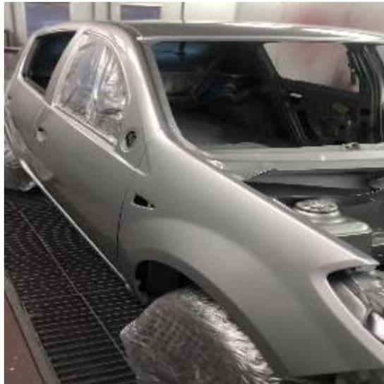
*Nota.* En la imagen se puede observar el compacto listo y el vehículo colocado la carrocería para comenzar con el proceso de pintura.
