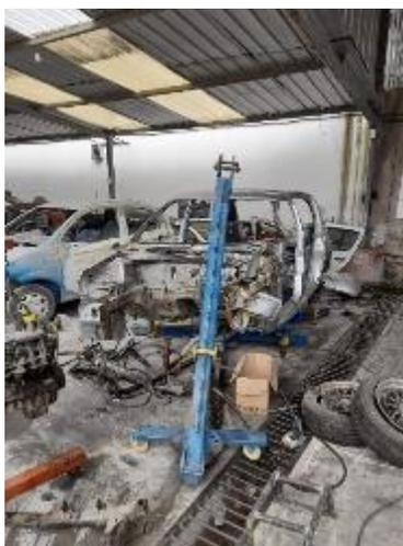
*Nota.* En la imagen se puede observar el desmontaje de los elementos principales del vehículo Renault Sandero 2011
