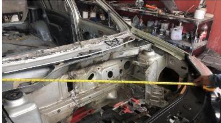
*Nota.* En la imagen se puede observar mediciones del compacto para seguir realizando las respectivas correcciones.
