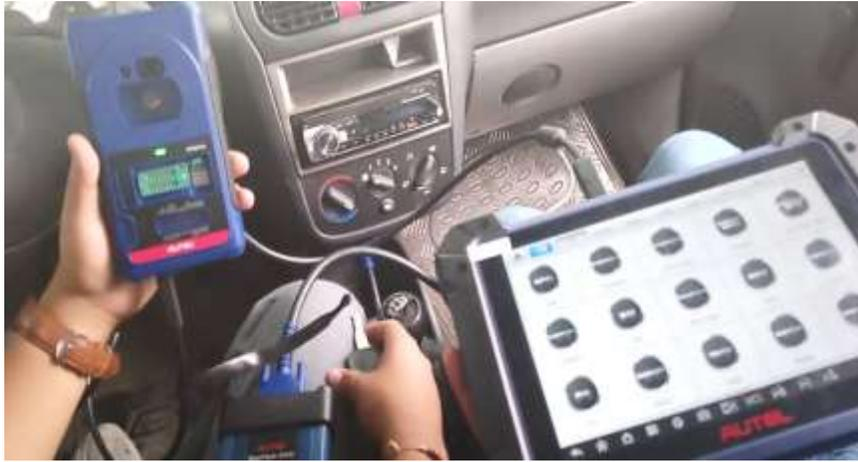
*Nota.* Se realiza la respectiva conexión con el cable que va al puerto USB del XP400PRO y con la llave en su lugar, nos dirigimos a la interfaz del AUTEL IM608PRO, donde seleccionamos la marca del vehículo, en este caso, OPEL, y específicamente el modelo Corsa C. Este paso es crucial para personalizar la configuración y garantizar que el dispositivo esté preparado para interactuar de manera óptima con el sistema del vehículo en cuestión.
