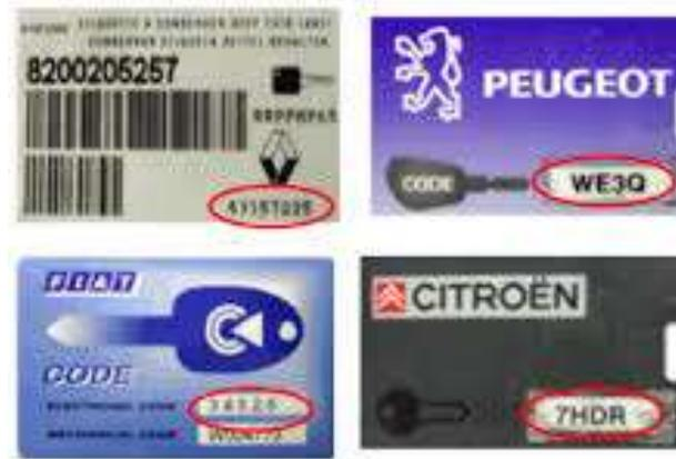
*Nota.* En la figura se ilustra la obtención del Pin code a través de tarjeta en distintas marcas de vehículos. *Tomado de (Mecanica Automotriz, 2021)*
