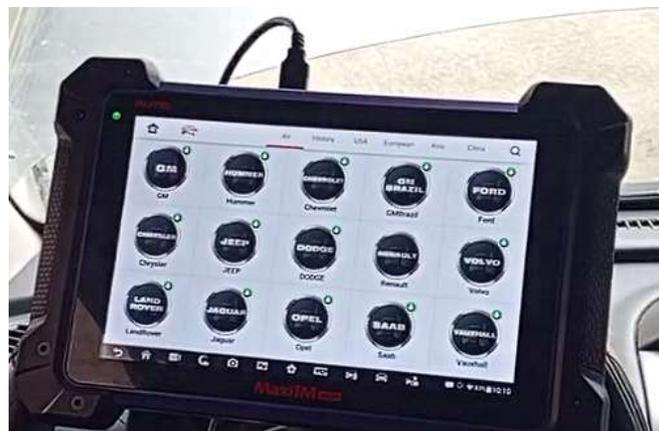
*Nota.* Para iniciar el proceso de programación de la llave, es esencial acceder al sistema AUTEL IM608PRO e ingresar detalladamente la información específica del vehículo. Este paso implica proporcionar datos precisos como el modelo del vehículo, el año de fabricación y cualquier otra información relevante que pueda ser requerida por el dispositivo. Esta etapa asegura que la programación se realice de manera eficaz y acorde con las especificaciones técnicas del vehículo en cuestión.
