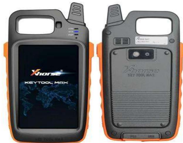
*Nota.* Se identifica en esta figura el equipo Clonador, que tiene la capacidad de clonar llaves e identificar el ID de los chips que contiene las llaves establecidas. Tomado de (Copyrights, 2017)
