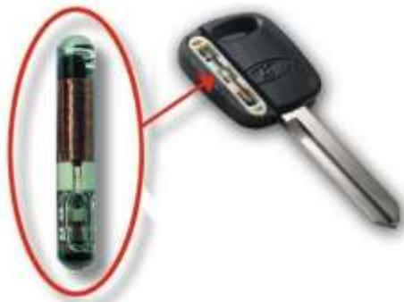
*Nota.* Se inspecciona la función del chip en la llave con transponder para extraer el Pin code.
