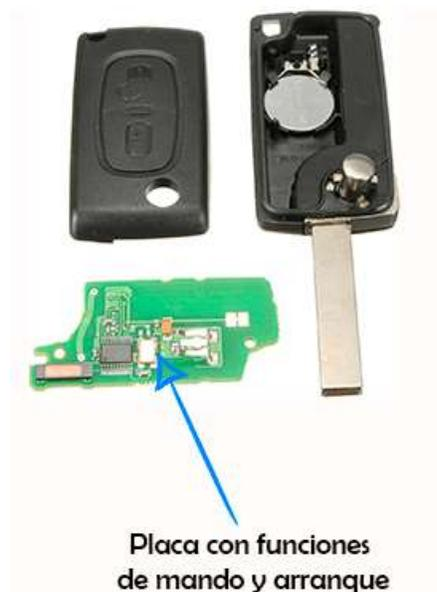
*Nota.* Se muestra en la siguiente imagen la posición del chip y la placa con mando que tiene la llave transponedora. Tomado de (Online, 2022)
