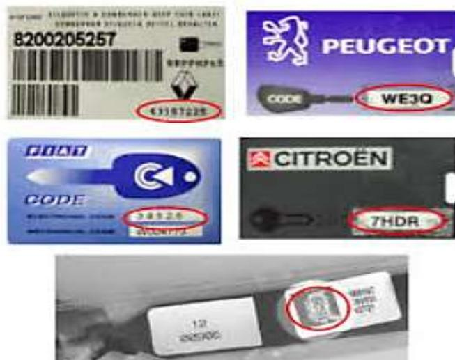
*Nota.* Se determina en la figura la extracción del Pin code por tarjeta de las diferentes marcas de vehículos. *Tomado de (Marlon, 2020)*
