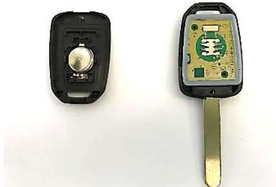
*Nota.* Se identifica en la siguiente imagen la posición del chip y el cabezal electrónico que tiene la llave transpondedora. *Tomado de* (Chavez, 2020)
