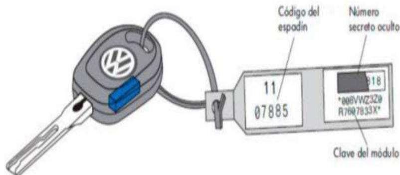
*Nota.* Se especifica la determinación del Pin code que contiene la llave para facilitar el acceso al inmovilizador. *Tomado de* (Marlon, 2020)
