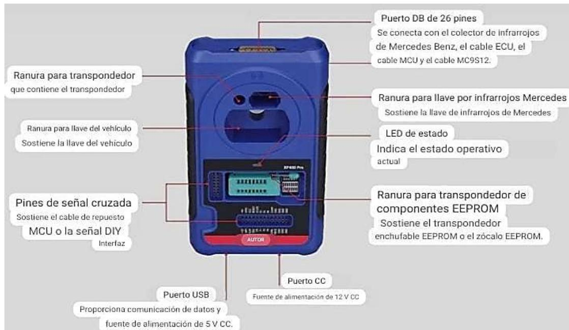
*Nota.* Se indica el instrumento XP400PRO para la lectura de llaves inmovilizadores con transponder, determinando la marca del vehículo y su ID del chip. *Tomado de (Autel, 2023)*
