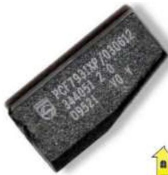
*Nota.* Se identifica el tipo de superchip fijo con su código respectivo de seguridad. Tomado de (Perca, 2019)
