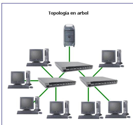
*Nota.* En la figura se observa el diseño físico de la red en árbol. Recuperado de (Tinet, 2022).
