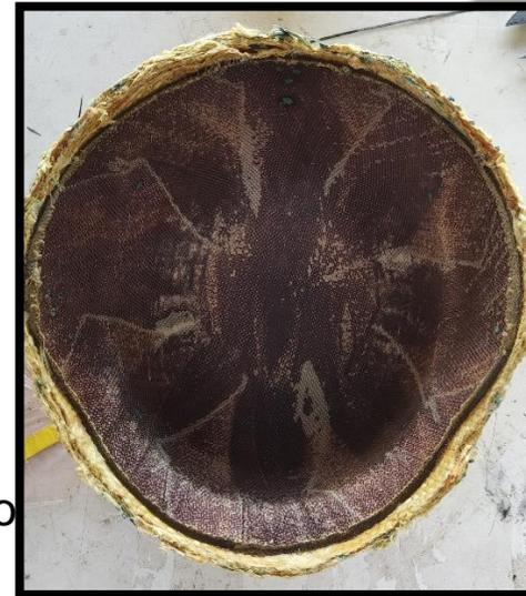
Figura 12. Resultados ensayo balístico casco reparado.
