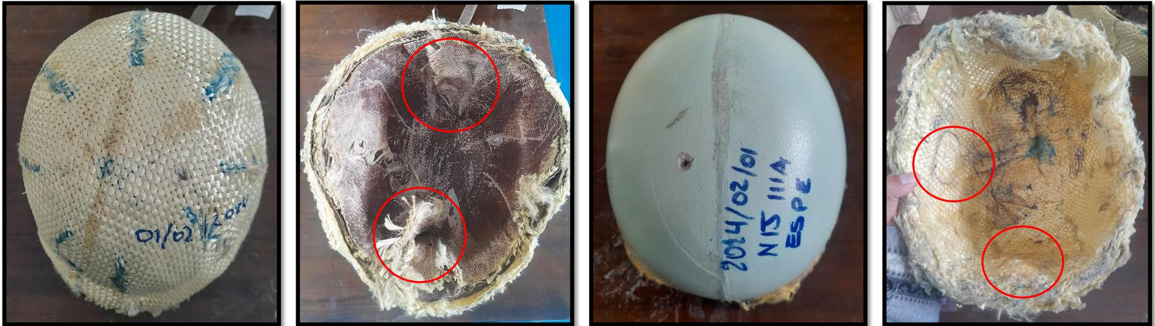
Figura 14. Comparación de resultados de ensayo balístico casco reparado - fabricado.
