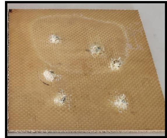
Figura 11. Resultados ensayo balístico probetas.
