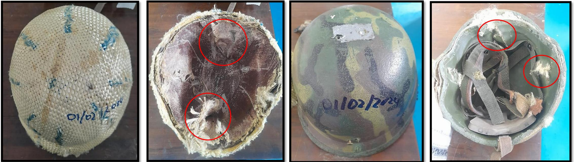
Figura 13. Comparación de resultados de ensayo balístico casco reparado - caducado.
