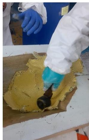
Mientras se coloca cada capa, se utiliza un rodillo, que, mediante presión controlada, compacta las capas recién aplicadas. Este proceso de compactación es crucial para asegurar una unión sólida y uniforme entre las capas de Kevlar y la capa externa del casco.
