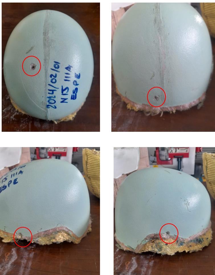
Este ensayo fue aprobado debido a que los proyectiles no traspasaron el casco por completo, se debe tomar en cuenta que las fibras del Kevlar poseían la configuración de 0°-45°-90 y que tuvo una capa de fibra de vidrio con resina, sin embargo, para el estudio no se tomó
