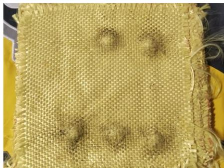
La medición se lleva a cabo de manera manual, ya que durante el ensayo se colocó una placa de plastilina detrás de la probeta para registrar las deformaciones resultantes como se observa en la figura 22. Es importante destacar que la plastilina no afectó la trayectoria de los proyectiles ni ofreció resistencia a la probeta, dado que es un material dúctil que se deforma fácilmente ante fuerzas de magnitudes reducidas.
