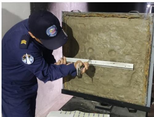
Para medir las deformaciones proporcionadas por el impacto de la bala, se utiliza un calibre para obtener la profundidad de cada impacto en la plastilina. En la figura 23, se detalla la posición de cada impacto.
