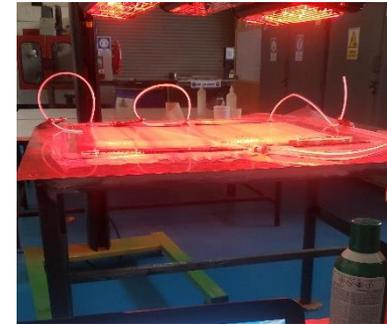
Aplicación del cemento de contacto y curado
