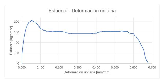
Nota. Se muestra la curva esfuerzo deformación obtenida para el filamento 3.
