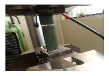
Nota. Probeta sometida a tensión con fibras perpendiculares y falla de esta.
