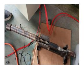
Nota. Limpieza de cañón, resistencias y tornillo sin fin de la extrusora
