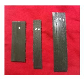
Nota. Muestras de probetas recortadas para calcular la densidad del material.
