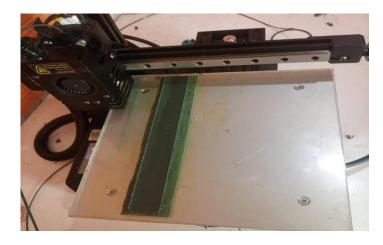
Nota. Proceso de impresión de las probetas que serán sometidas a ensayos de tensión.
