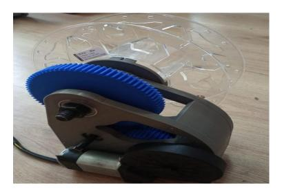
Nota. Impresión 3D del mecanismo de enrollado y armado del mismo.
