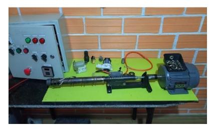
Nota. Montaje de banco de pruebas para ensayos de filamento con plástico fundido
