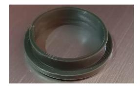
Nota. Se observa el modelo impreso en 3D obtenido con el filamento obtenido.
