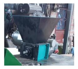
Nota. Maquina utilizada para la trituración de plasticos y obtención de la escama de estos
