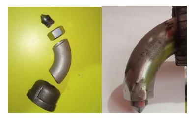
Nota. Se muestra los elementos que conforman la boquilla y armado de esta
