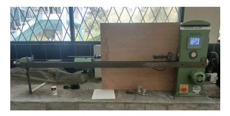
Nota. Maquina utilizada para realizar en ensayo de tensión en las muestras de filamento.
