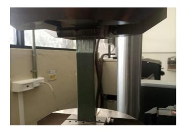
Nota. Muestra de cómo fallan las probetas con fibra paralela en el ensayo de tensión.
