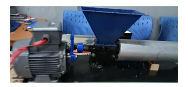
Nota. Maquina extrusora utilizada para la fundición de plásticos y obtención de filamento
