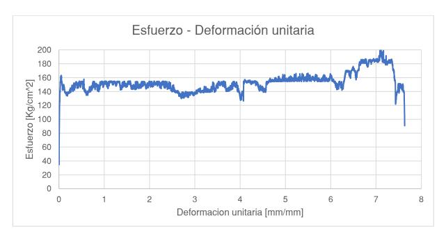
Nota. Se muestra la curva esfuerzo deformación obtenida para el filamento 1.
