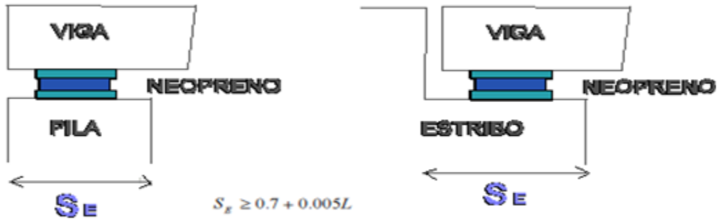
Figura 5-134 Apoyos sobre pilas y estribos
