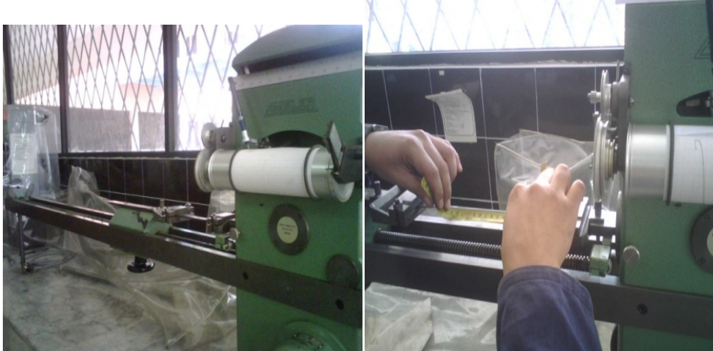
Figura 4-70 Equipo del laboratorio para el ensayo de tracción
