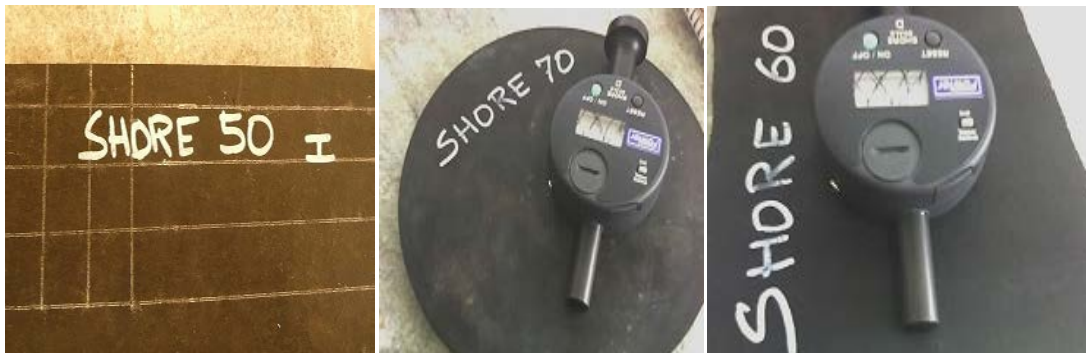
Figura 4-61. Elastómeros utilizados en el ensayo de dureza
