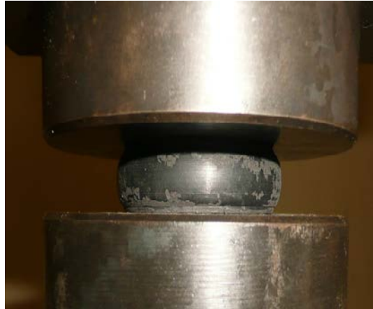
Probeta con fuerza de compresión a 25%
