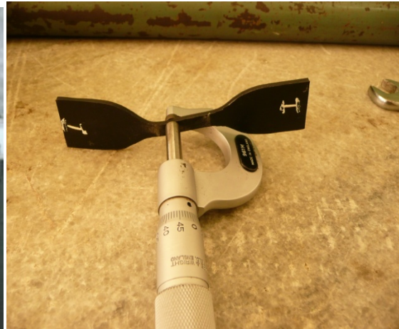
Figura 4-68 Medición de las probetas elastómeras para el ensayo
