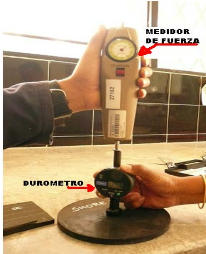
Figura 4-60 Medición de dureza en el elastómero
