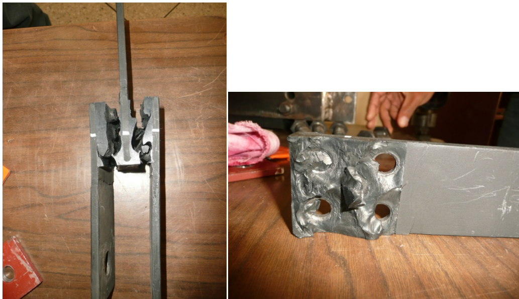
Figura 4-93 Desplazamiento 150% colapso la probeta
