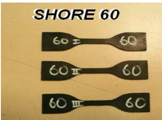
Figura 4-68 Medición de las probetas elastómeras para el ensayo
