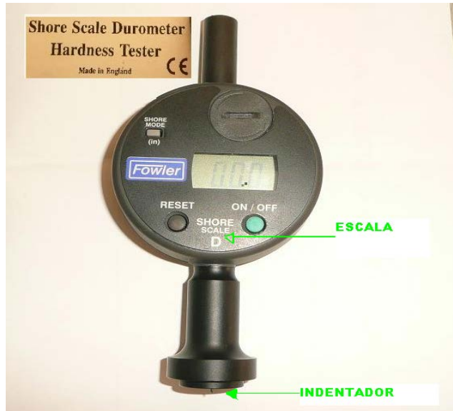
Figura 4-57 Equipo de medida de dureza DURÓMETRO SHORE D.
