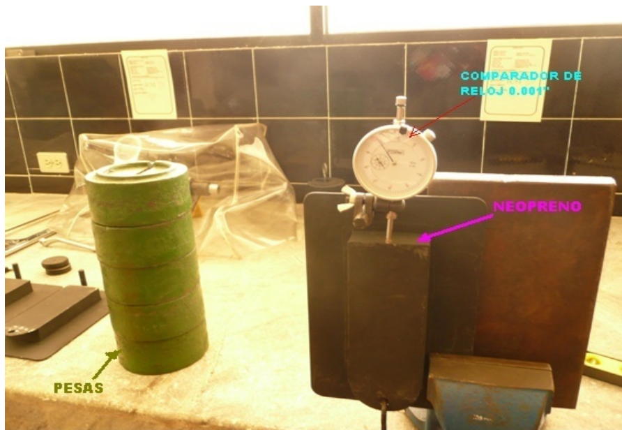
Figura 4-129 Equipo para el ensayo de corte
