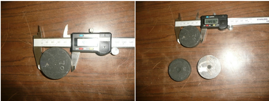
Figura 4-111 Medición de las probetas para el ensayo de compresión
