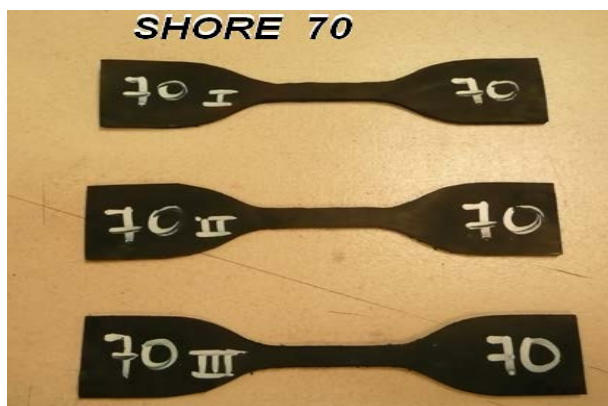
Figura 4-69 Probetas elastómeras shore 50, 60 y 70
