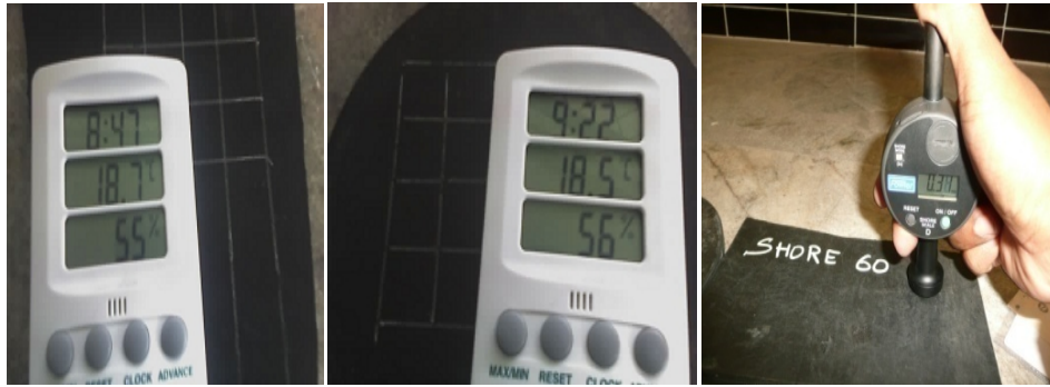
Figura 4-63 Medición de temperatura y dureza a cada hora en el prototipo
