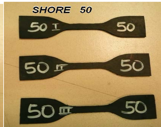
Figura 4-68 Medición de las probetas elastómeras para el ensayo
