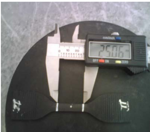
Figura 4-68 Medición de las probetas elastómeras para el ensayo
