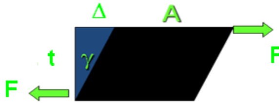
Figura 4-130 Funcionamiento del ensayo a corte
