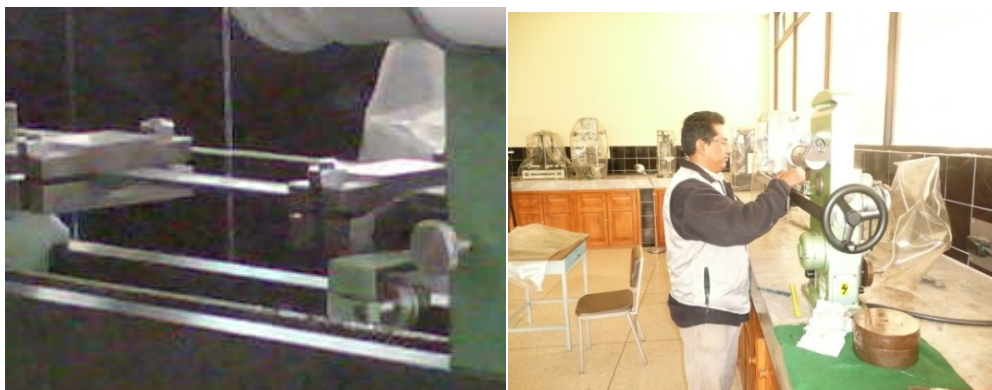
Figura 4-71 Ensayo de las probetas elastómeras a tracción
