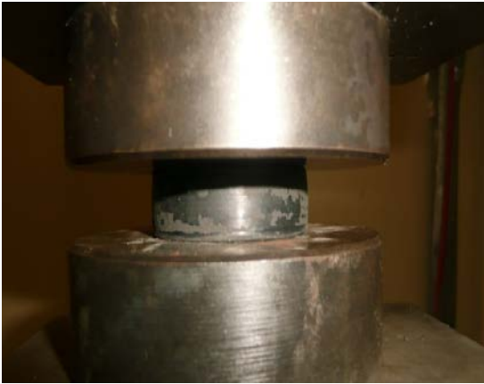
Probeta sin fuerza de compresión
