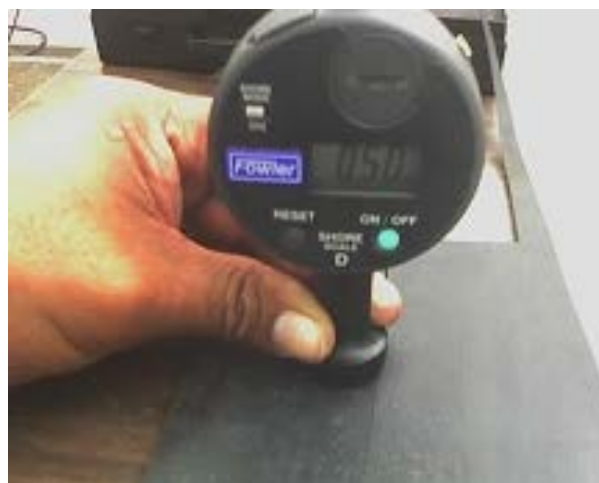
Figura 4-58 Realización de medición en caucho
