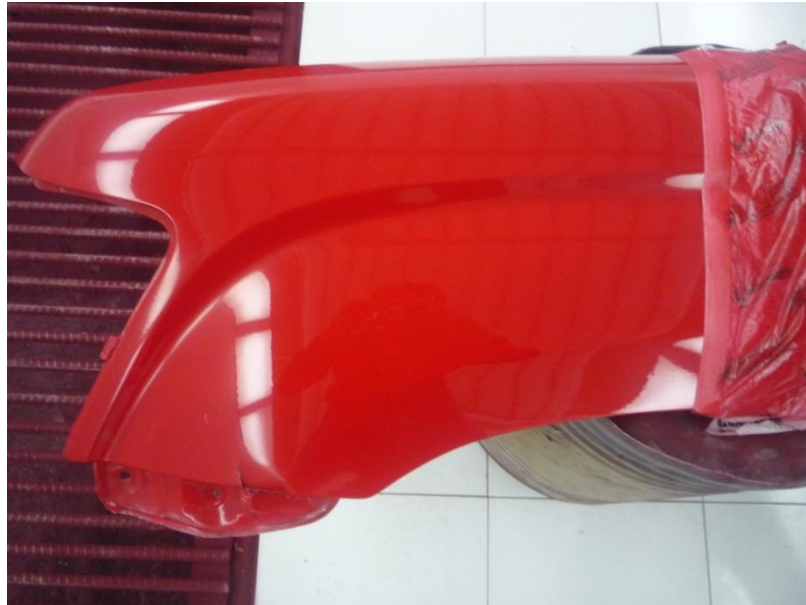
Figura. 6.19. Repinte en la cabina de pintura.
