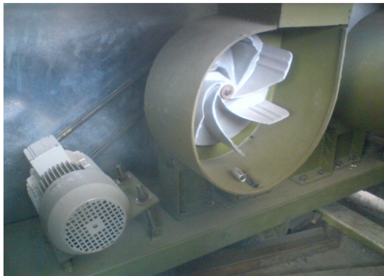
Fig. 5.21. Turbina de impulsión de aire.
