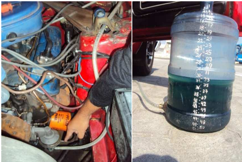
Fig. 6.1 Cañería de la Bomba de Combustible. Fig. 6.2 Recipiente de combustible.
