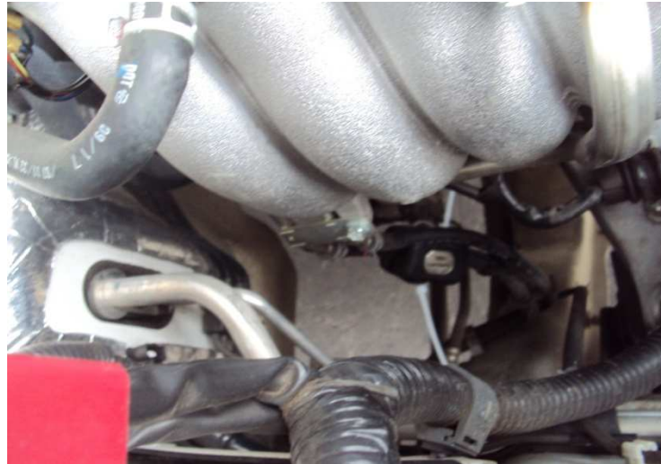
Figura 4.20 Magnetizador en la tubería de Alimentación.
