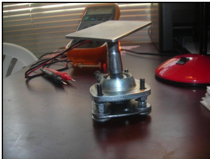
Figura 4.13: Base Metálica para el sensor de aceleración.
