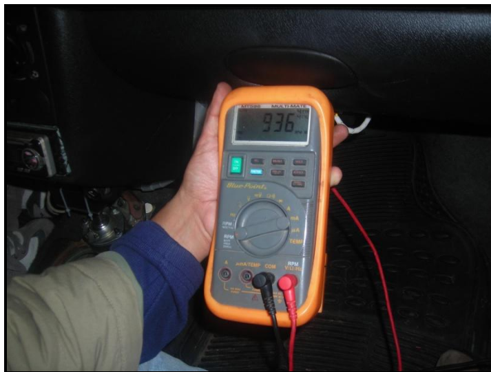
Figura 4.25: Ensayo de revoluciones con el Multímetro BLUEPOINT MT586
