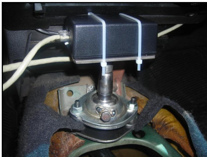
Figura 4.15: Montaje del sensor G.
