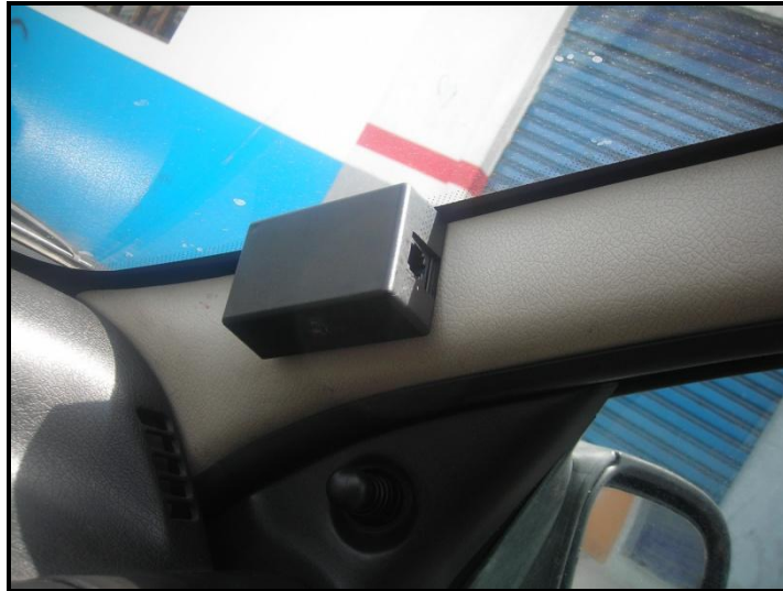
Figura 4.10: Montaje del sensor de temperatura.
