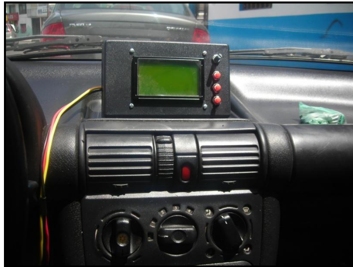
Figura 4.4: Montaje de la pantalla GLCD.
