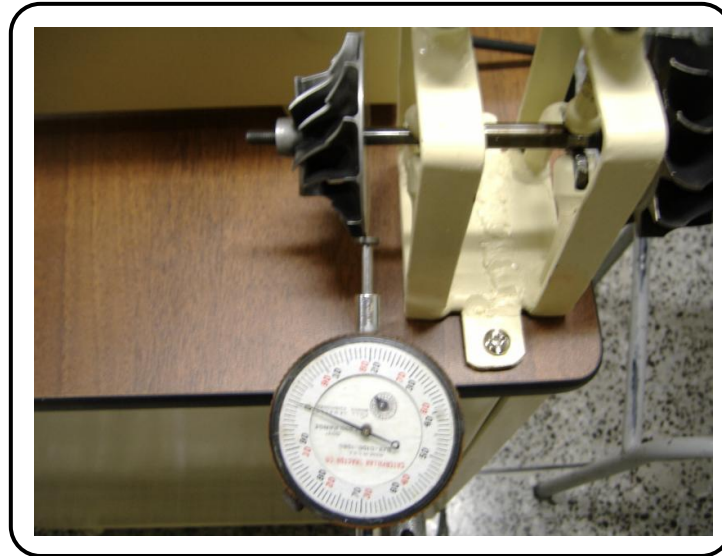
Figura 4.23. Medición del alabeo
