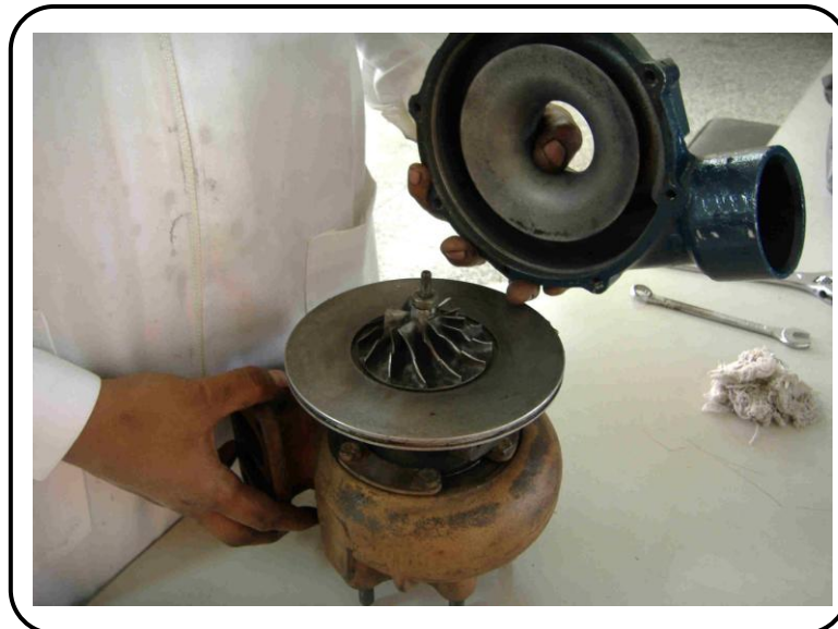
Figura 4.23. Desarmado de un turbocompresor
