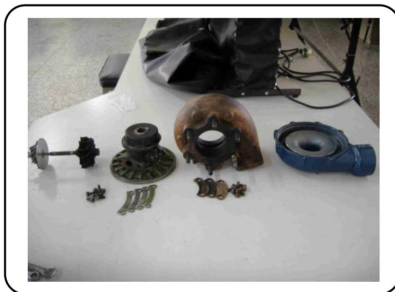
Figura 4.24. Inspección visual de los componentes del turbocompresor
