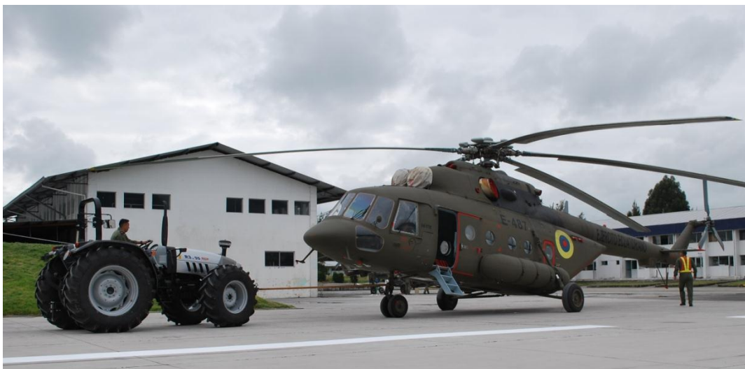
Figura No. 3.12.- Remolque de una aeronave en plataforma.
