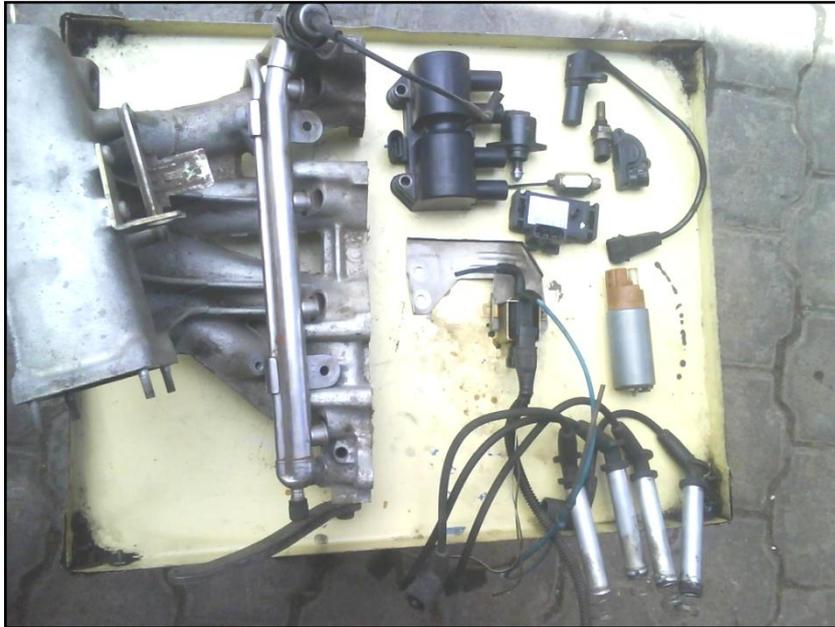
**Figura 2.3: Elementos que conforman el sistema de inyección electrónica.**
