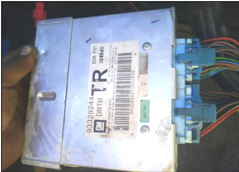
**Figura 2.4: Unidad de control electrónico (ECU).**
