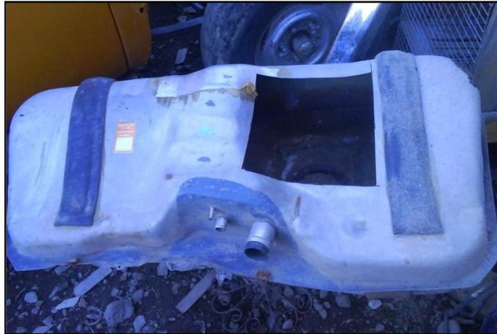
**Figura 2.33: Corte del orificio para alojamiento de la bomba de combustible.**
