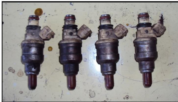
**Figura 2.37: Inyectores electrónicos de combustible.**
