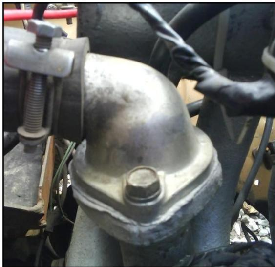
**Figura 2.27: Elemento del sistema de refrigeración suprimido.**
