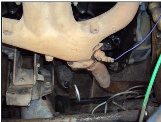
**Figura 2.31: Sensor EGO instalado.**
