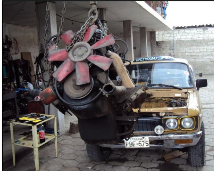
**Figura 2.14: Desmontaje del motor.**
