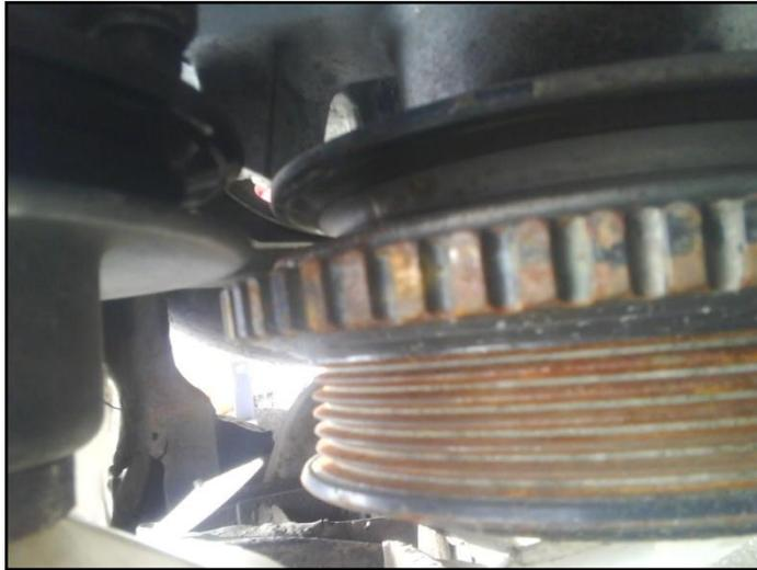
**Figura 2.34: Polea del cigüeñal del sensor CKP.**
