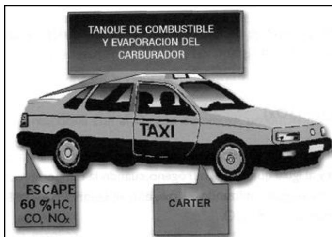
**Figura 1.37: Fuentes de contaminación en un vehículo.**
