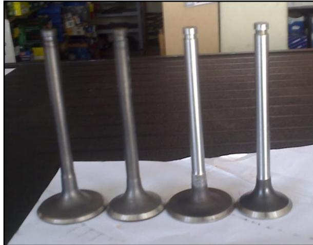
**Figura 2.24: Izquierda válvulas nuevas Isuzu 2300, derecha válvulas G16.**
