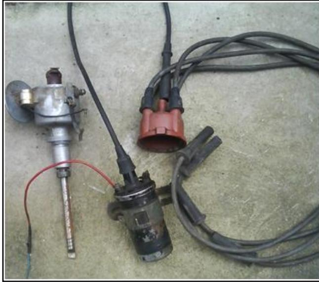
**Figura 2.26: Elementos del sistema de encendido convencional suprimidos.**
