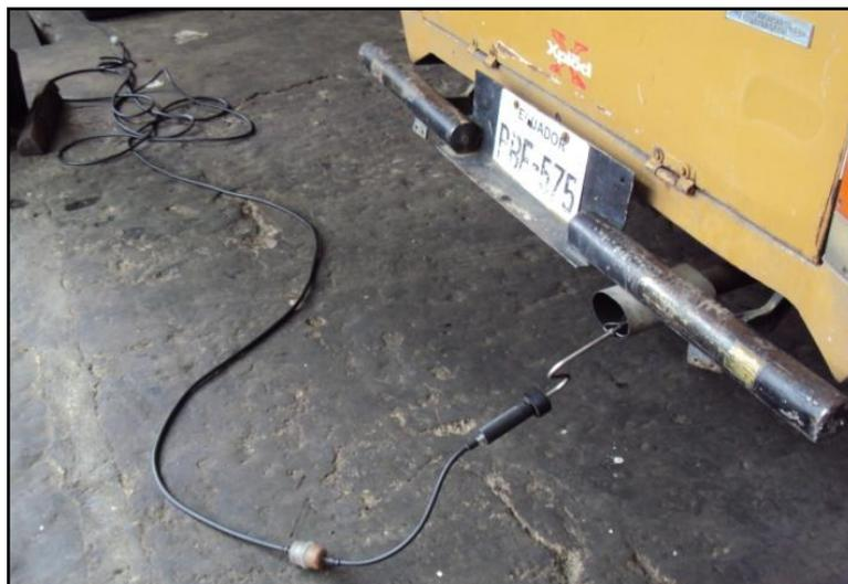
**Figura 3.29: Ubicación de la sonda del analizador de gases.**
