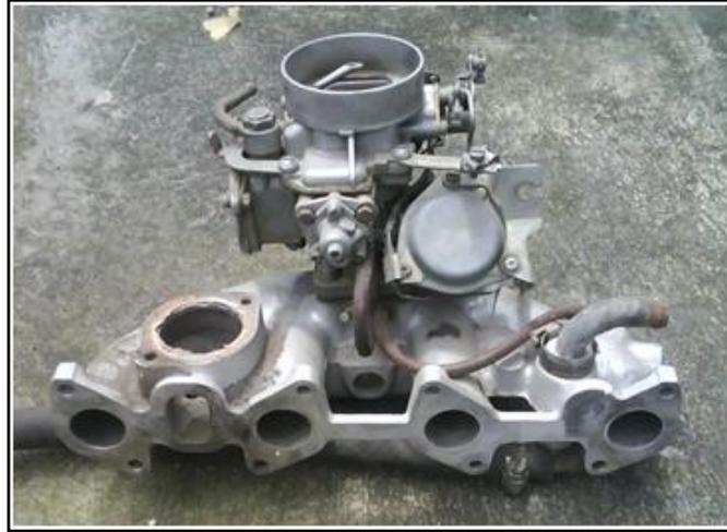
**Figura 2.28: Elemento del sistema de admisión de aire suprimido.**
