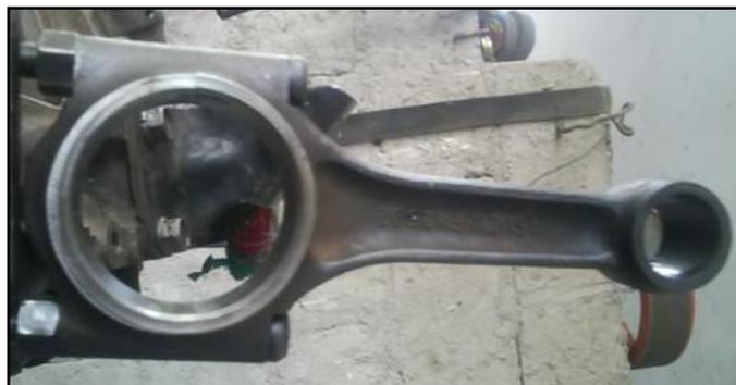
**Figura 2.22: Biela original del motor G16.**
