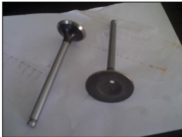
**Figura 2.23: Válvulas de admisión y escape sustituidas.**
