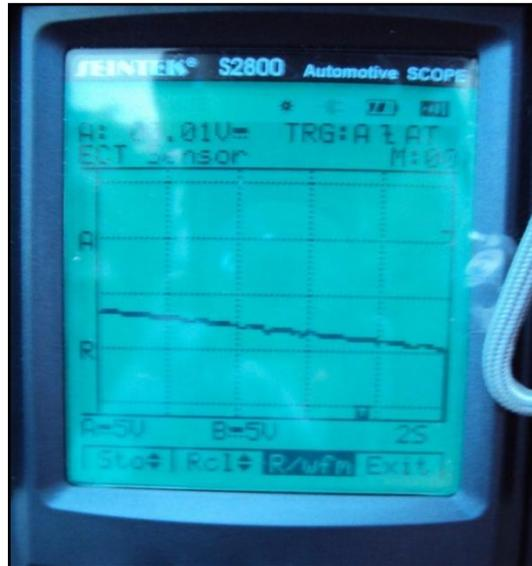
**Figura 3.13: Medición del sensor ECT.**
