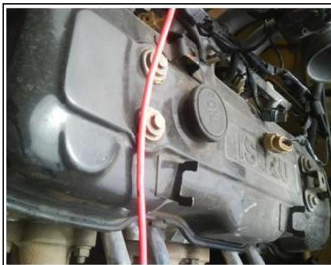
**Figura 2.15: Desmontaje de la tapa de válvulas.**
