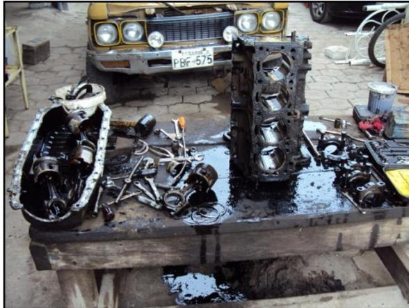
**Figura 2.19: Block vacío del motor.**
