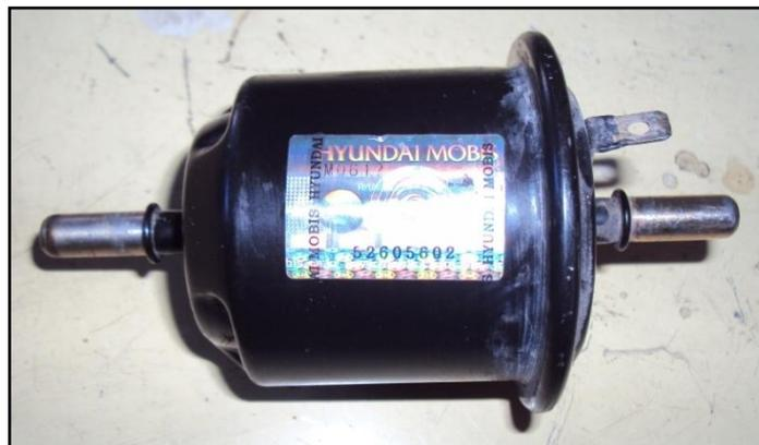
**Figura 2.39: Filtro de gasolina común para un sistema de inyección electrónica.**
