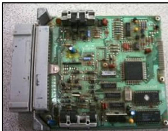
**Figura 1.12: Estructura interna de la ECU.**
