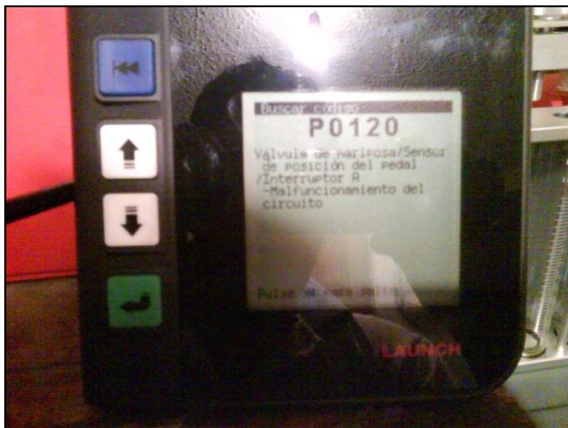
**Figura 2.6: Pantalla del Escáner LAUNCH.**
