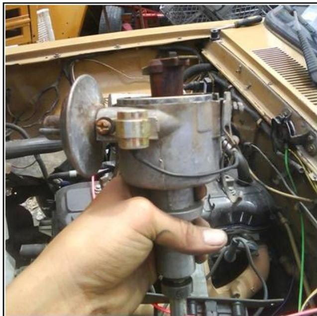
**Figura 2.9: Desmontaje del distribuidor de encendido.**
