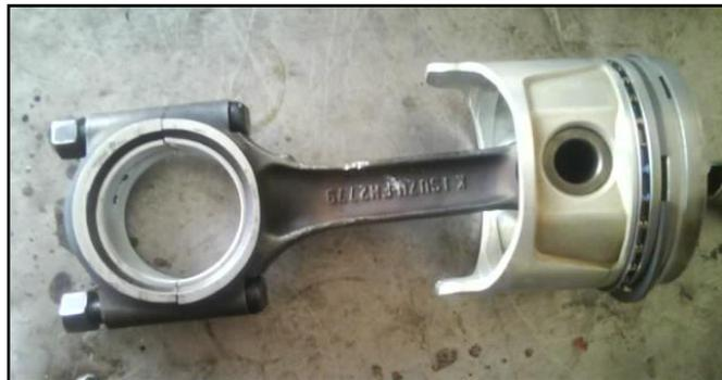
**Figura 2.21: Pistón del motor G18.**
