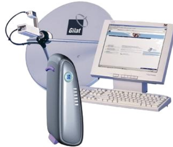
(a) Skystar 360E / Internet - transmisión de voz y datos
