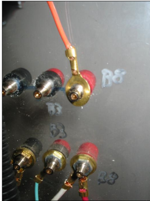
Figura 5.8 Perforaciones para los conectores de los sensores.
