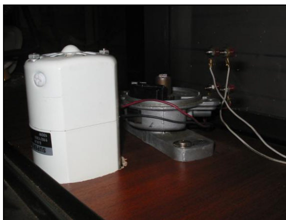
Figura 5.12. Motor eléctrico y distribuidor.
