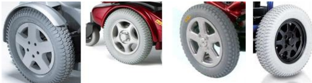
Figura 1.15 Ruedas traseras de distintos tamaños y materiales
