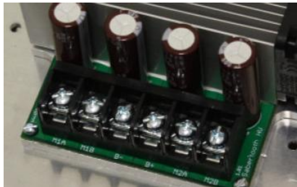
Figura 2.29 Terminales de la batería y motores
