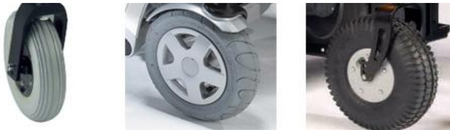
Figura 1.14 Ruedas delanteras de distintas cubiertas; a) Neumáticas; b) Macizas; y c) de Aire
