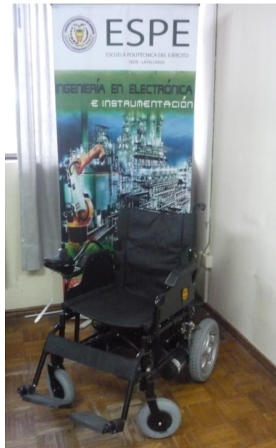
Figura 2.1 Silla de ruedas eléctrica modelo XFG-103 FL de tipo plegable
