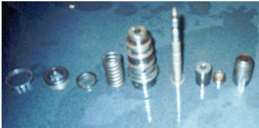
**FIGURA 6.7 DESARMADO DEL INYECTOR**
