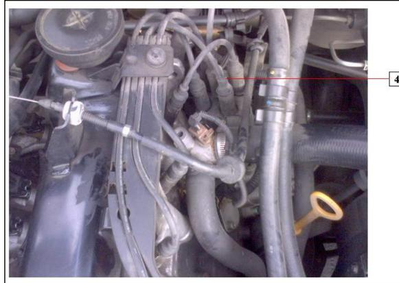
Figura 2.9. Ubicación del distribuidor en el motor
