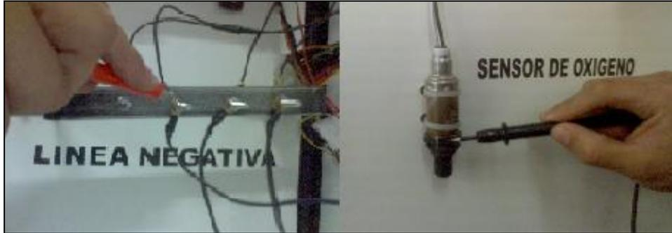
Figura 4.47. Verificación de la masa de la carcasa de la sonda
