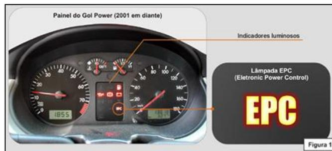
**Figura 4.23. Luz Indicadora de Malfuncionamiento**
