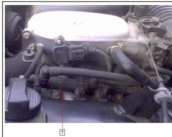
Figura 2.12. Ubicación del riel de inyección en el motor
