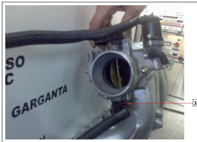
Figura 2.8. Ubicación del sensor TPS en el motor
