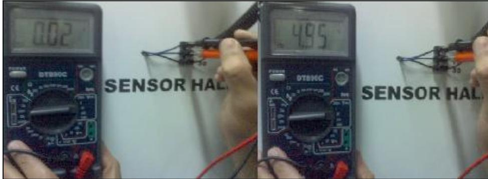
Figura 4.39. Variación del Voltaje de Señal del Sensor Hall
