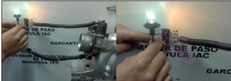
Figura 4.45. Verificación de la señal de control para el IAC.
