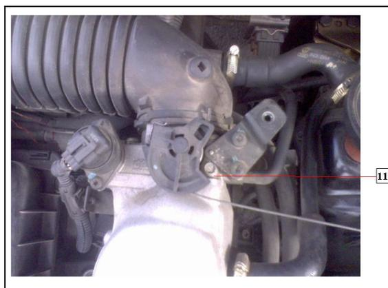
Figura 2.16. Ubicación del cuerpo de la mariposa de aceleración en el motor
