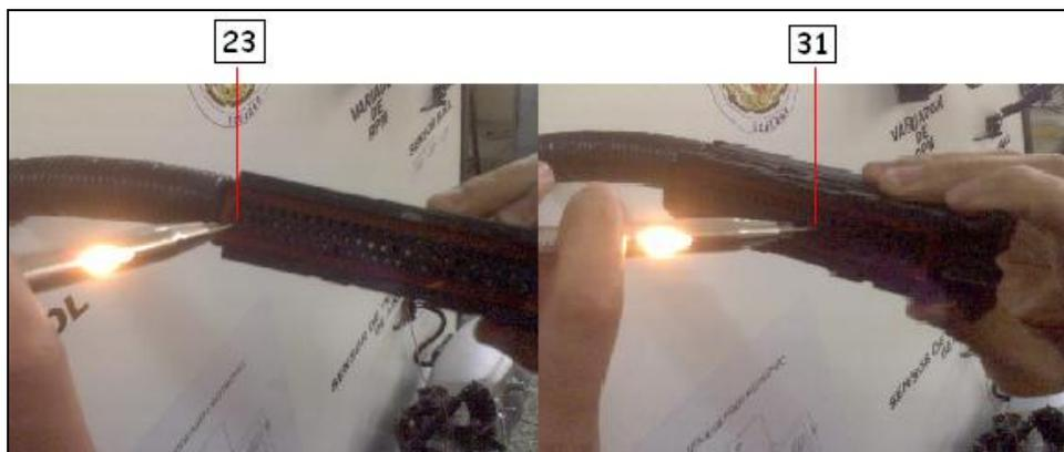
**Figura 4.57. Verificación de la alimentación positiva de la ECU**
