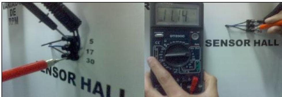
Figura 4.37. Medición del Voltaje de Referencia del sensor Hall
