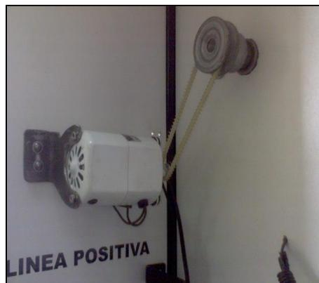
**Figura 4.14. Motor Eléctrico y Banda Transportadora**
