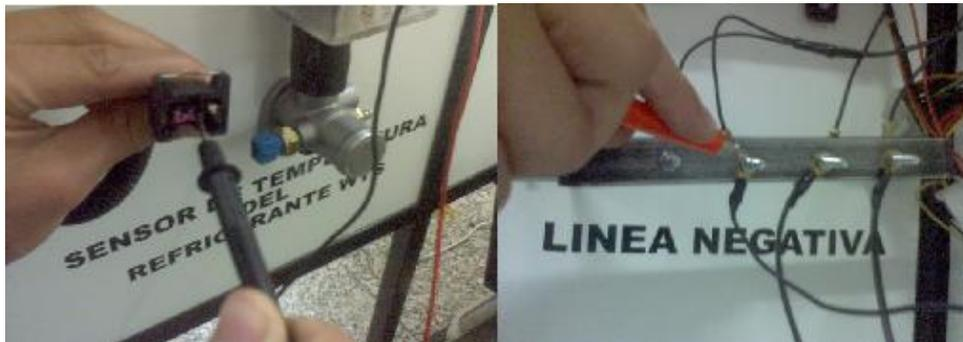
Figura 4.34. Verificación de la masa del sensor WTS
