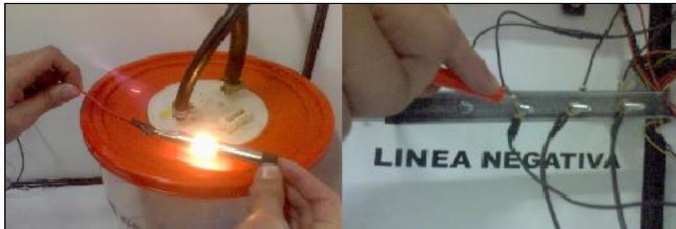
Figura 4.54. Verificación de alimentación de la Bomba
