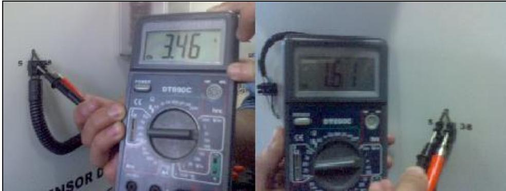
Figura 4.36. Variación del Voltaje de Señal del WTS
