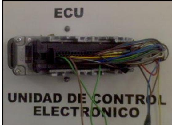
**Figura 3.2. Mando de Control Electrónico**
