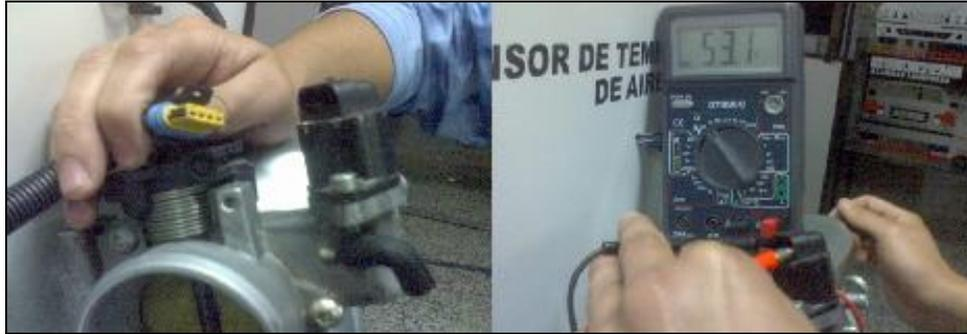
**Figura 4.46. Medición de resistencia de la bobina del IAC**
