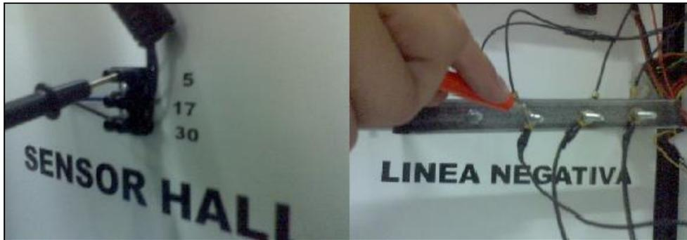
Figura 4.38. Verificación de la masa del sensor Hall
