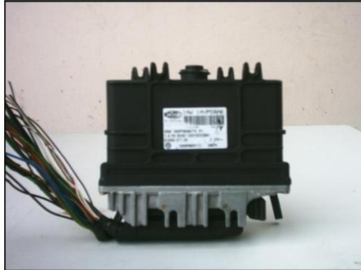
**Figura 2.1. Unidad de Control Electrónica MOTRONIC**
