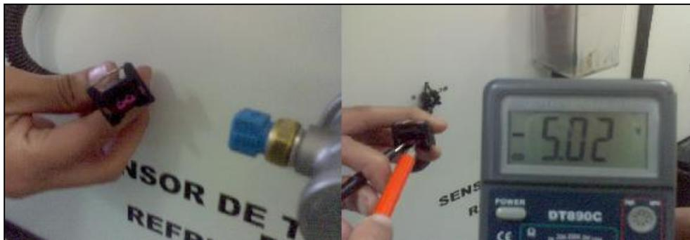
Figura 4.33. Medición del Voltaje de Referencia del sensor WTS
