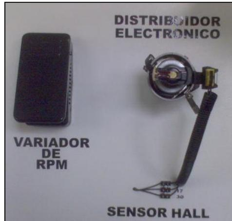
**Figura 4.13. Sensor hall en el Distribuidor Electrónico**
