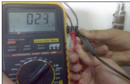
Figura 4.49. Medición de la resistencia de calentamiento de la sonda
