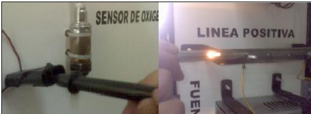
Figura 4.51. Alimentación negativa de la resistencia de calentamiento
