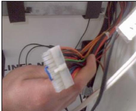
**Figura 4.4. Puente del Conector Principal de la Fuente**
