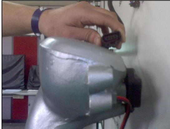
Figura 4.24. Desconecte el Conector del Sensor IAT/MAP
