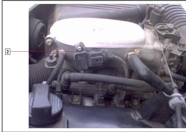
Figura 2.7. Ubicación del sensor IAT/MAP en el motor
