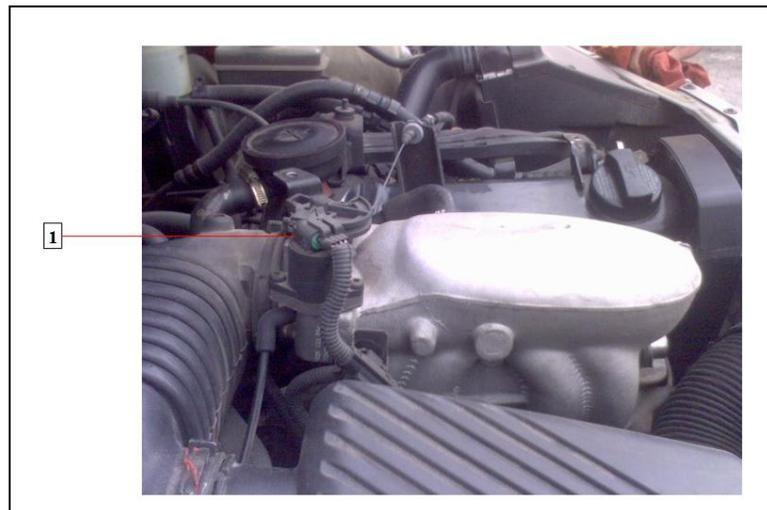
Figura 2.6. Ubicación de la válvula IAC en el motor
