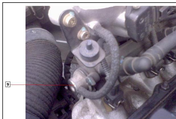
Figura 2.14. Ubicación del regulador de presión en el motor
