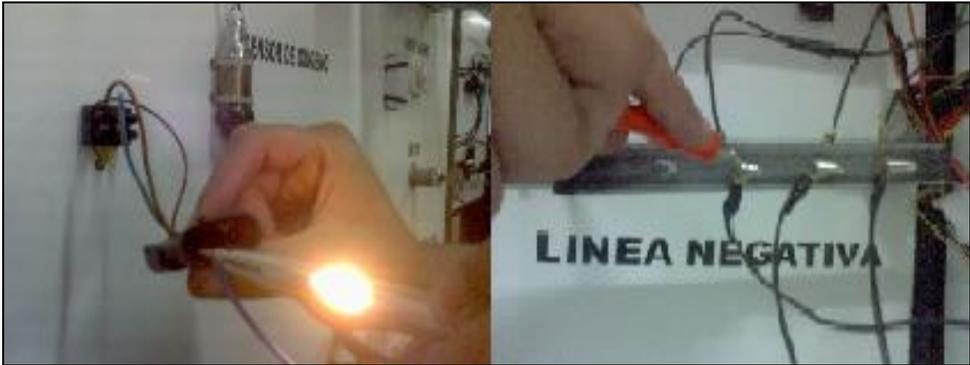
Figura 4.50. Alimentación positiva de la resistencia de calentamiento
