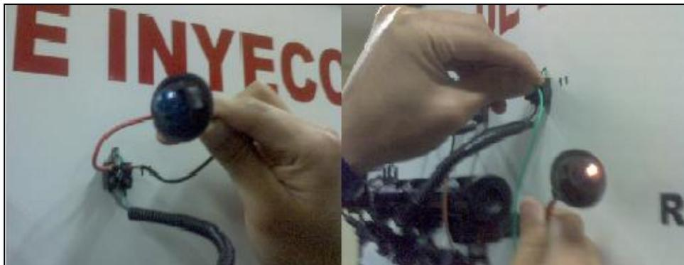
Figura 4.43. Verificación del control de los inyectores
