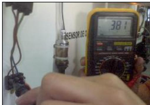
**Figura 4.52. Medición del Voltaje de Señal de la Sonda**
