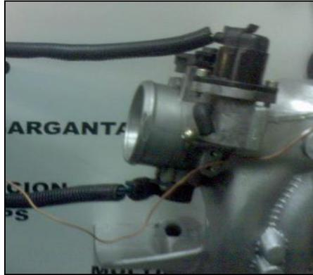
**Figura 4.11. Sensor TPS y Válvula IAC**
