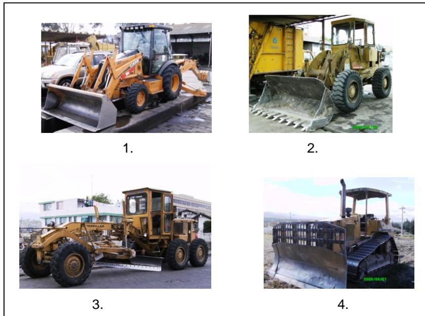
Figura 3.2 Maquinaria y Equipo Caminero: 1.Retroexcavadora; 2.Pala Cargadora de Ruedas; 3.Motoniveladora; 4.Tractor de Cadenas Tipo Bulldozer
