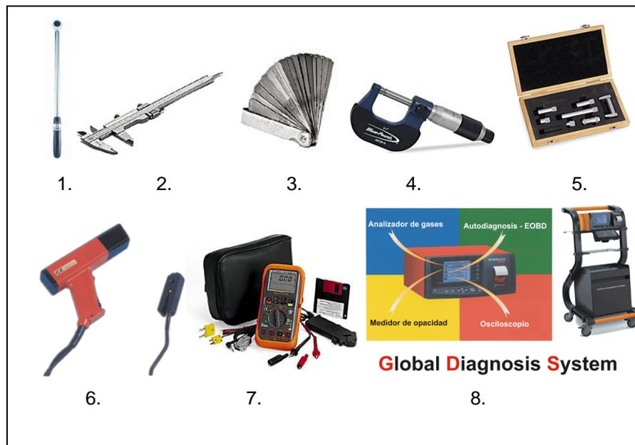
Figura 2.4 Algunas herramientas de medición y comprobación: 1. Torquímetro; 2. Calibrador Vernier; 3. Calibrador de láminas; 4. Micrómetro de exteriores; 5. Micrómetro de interiores; 6. lámpara estroboscópica; 7. Multímetro automotriz; 8. Equipo de diagnóstico computarizado.
