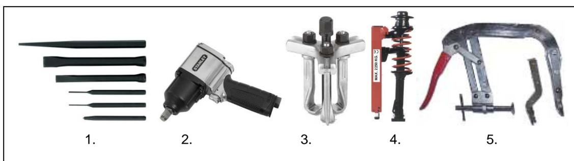
Figura 2.3 Algunas herramientas de Servicio Especial (SST): 1.Punzones; 2.Pistola neumática; 3. Extractor; 4. Compresor de resortes de suspensión; 5. Prensaválvulas
