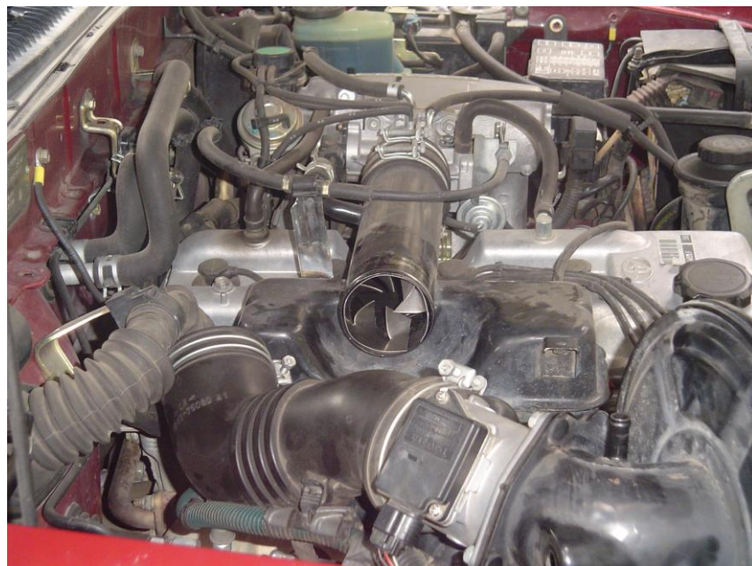
Fotografía 4.7 Dispositivo Generador Flujo Vórtice Instalado.
