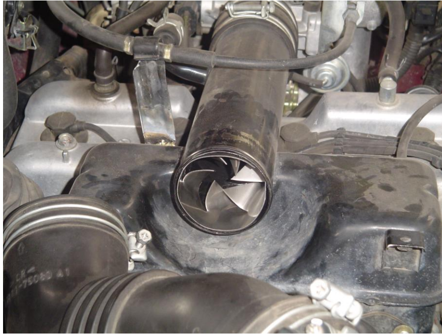
Fotografía 4.6 Dispositivo Generador Flujo Vórtice Instalado.
