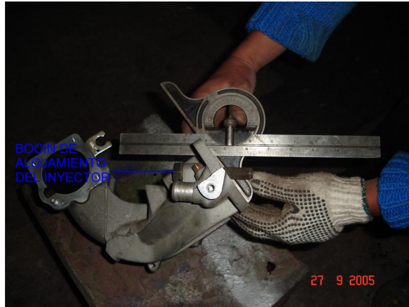
Figura 4.7.- Goniómetro transportador de ángulos.
