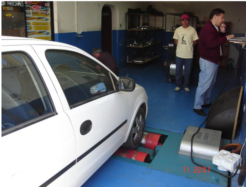
Figura 6.2.- Colocación de las ruedas motrices en los rodillos del dinamómetro.
