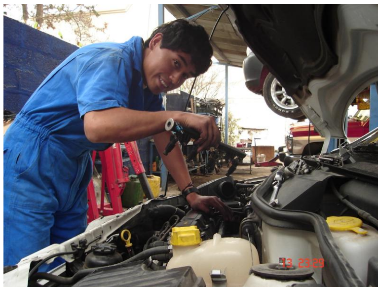
Figura 4.3.- Desmontaje de la Rampa de Inyección.
