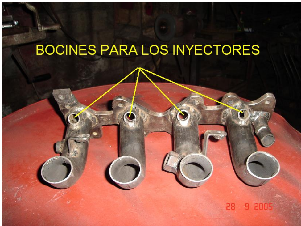
Figura 4.17.- Cordón de soldadura en los bocines.
