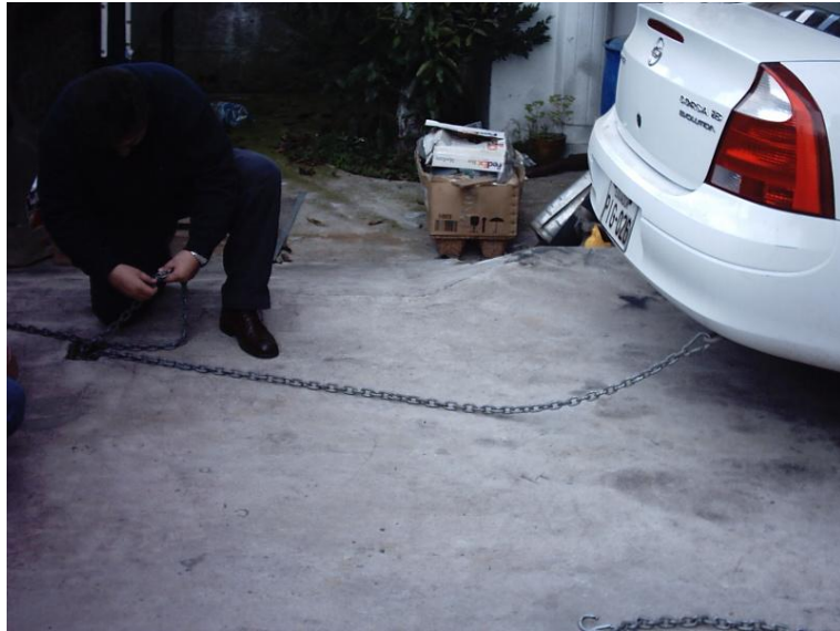
Figura 6.7.- Aseguramiento del vehículo con cadenas
