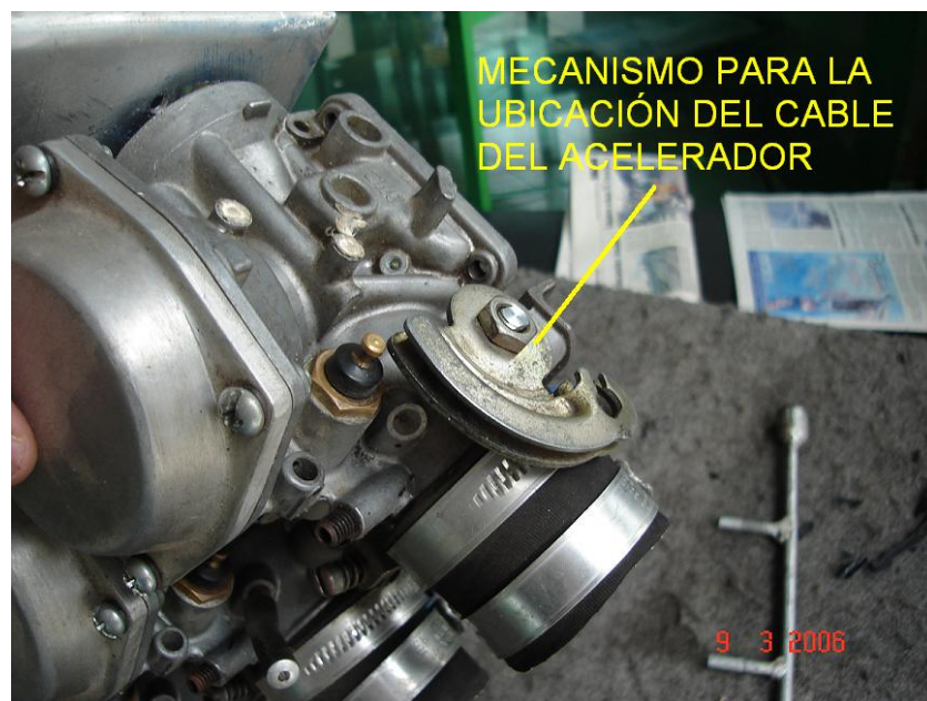
Figura 5.2.- Acople del cable de aceleración
