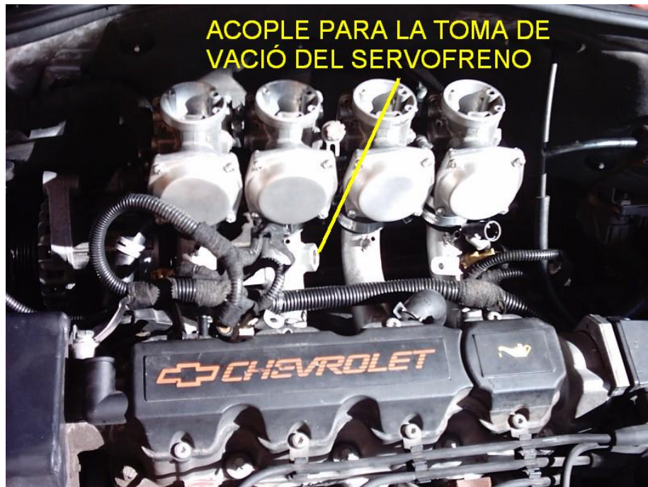
Figura 5.3.- Acople de la toma del servofreno
