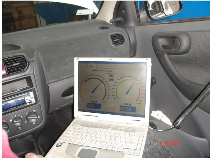
Figura 6.4.- Computadora del dinamómetro, la cual muestra velocímetro y tacómetro.
