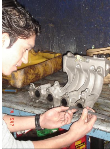
Figura 4.6.- Toma de medidas del Múltiple desmontado
