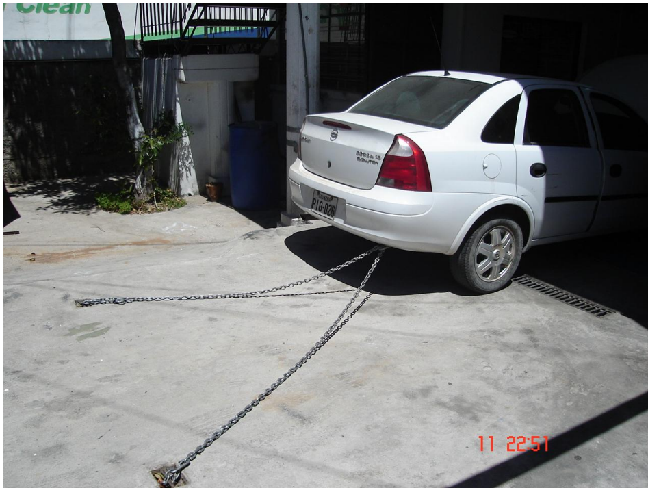
Figura 6.1.- Colocación de cadenas de seguridad para las pruebas en el dinamómetro.
