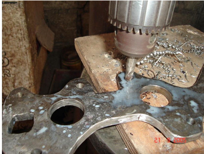
Figura 4.12.- Perforado para los espárragos en la Brida.
