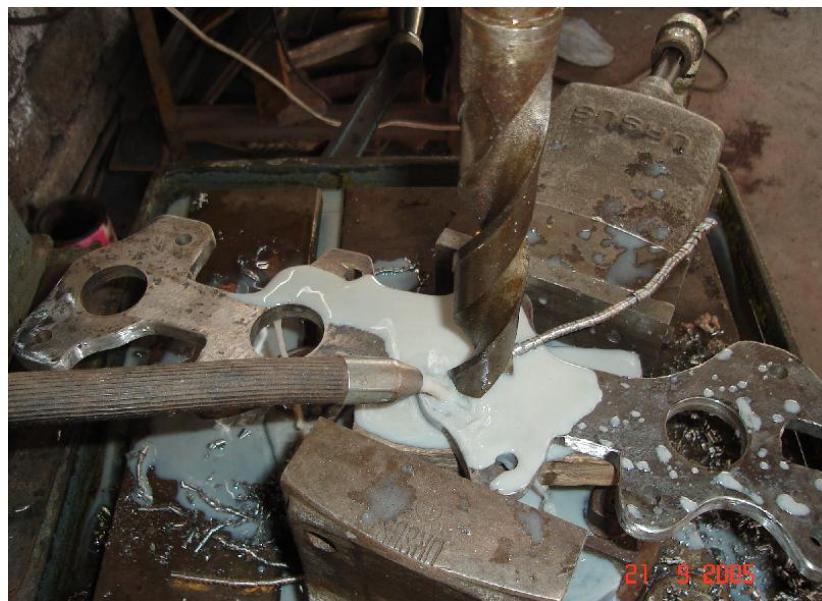
Figura 4.11.- Perforado de las tomas en la Brida.
