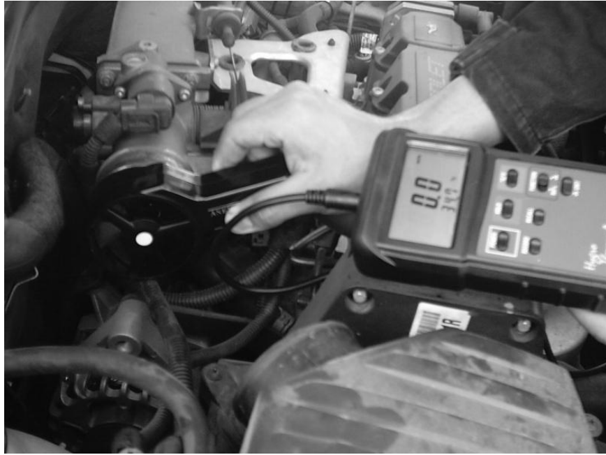
Figura 2.4.- Colocación del anemómetro
