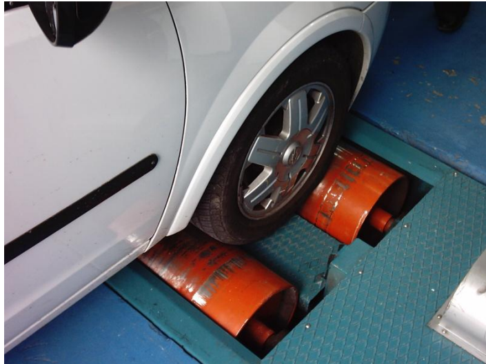
Figura 6.8.- Colocación de las ruedas motrices en los rodillos del dinamómetro
