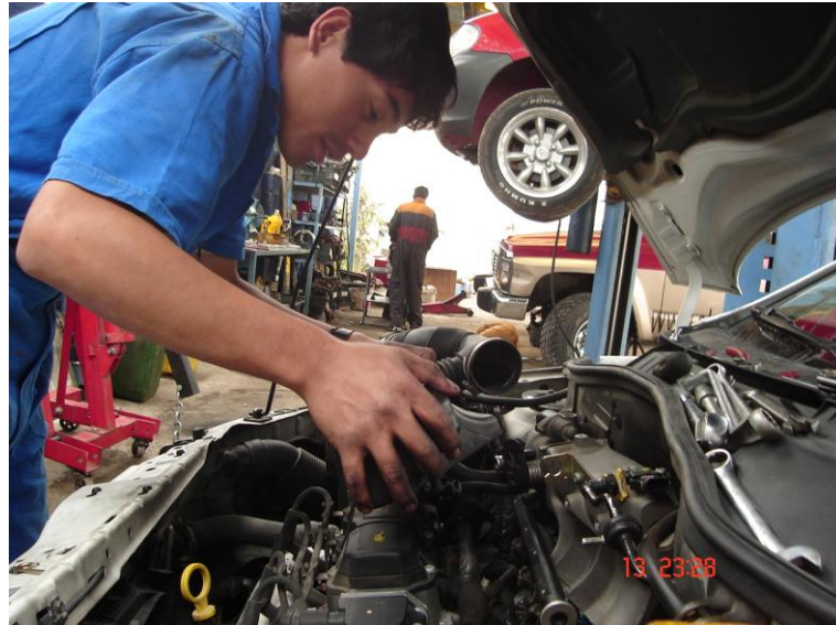
Figura 4.2.- Desmontaje del Depurador
