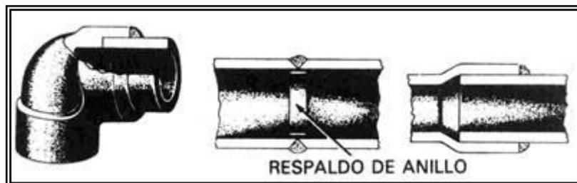
**FIGURA 3.7 CONEXIONES DE PLATINA**
