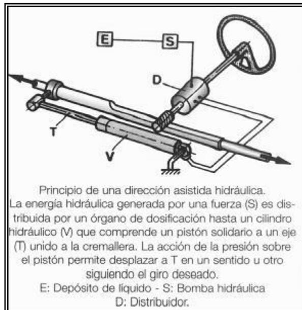
**FIGURA 2.3 DIRECCIÓN ASISTIDA HIDRAULICA**
