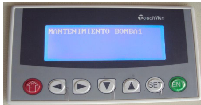
Figura 85: Alarma de mantenimiento de la bomba 1
