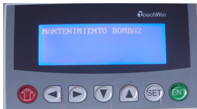
Figura 86: Alarma de mantenimiento de la bomba 2
