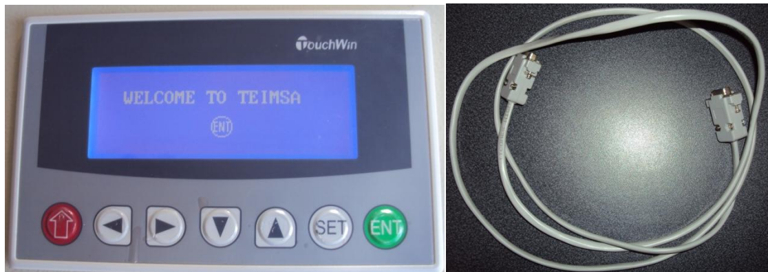
Figura 26: Visualizador de textos (OP320-S) y cable de conexión
