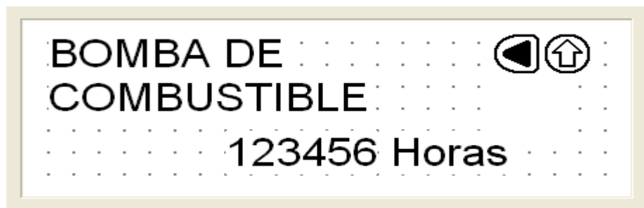
Figura 14: Pantalla de visualización de horas de bombas de combustible
