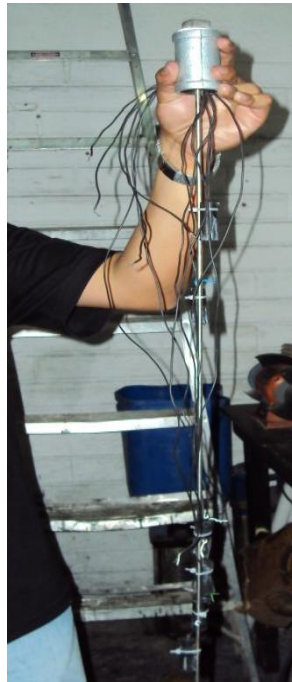
Figura 32: Ubicación de los sensores de nivel
