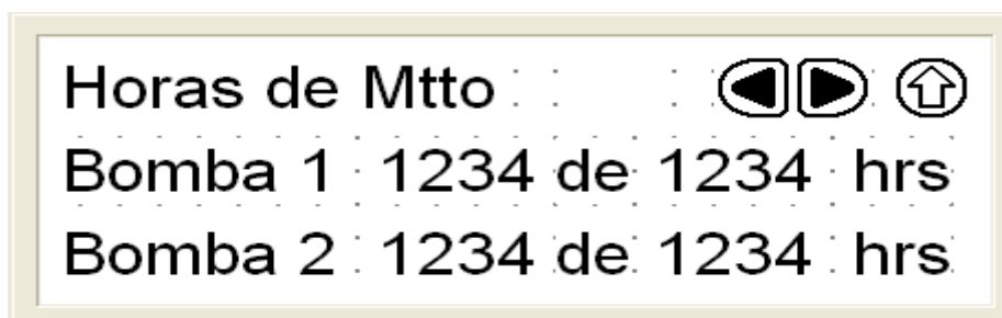
Figura 12: Pantalla de visualización de horas de mantenimiento de bombas
