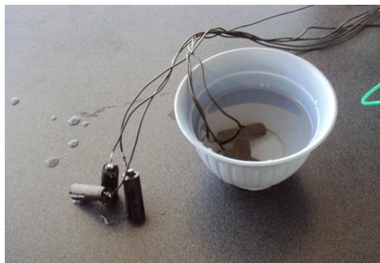
Figura 73: Pruebas de sensores de nivel
