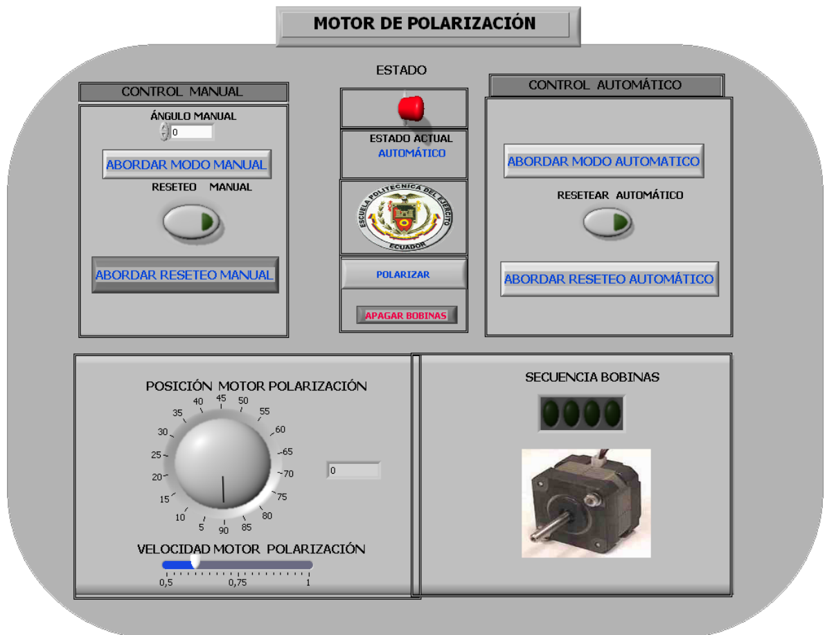
Figura 2.6.8 Panel Frontal del Motor de Polarización.
