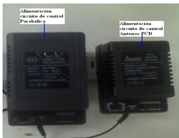
Figura 3.1.20. Adaptadores de alimentación para el circuito de control del sistema de movimiento.
