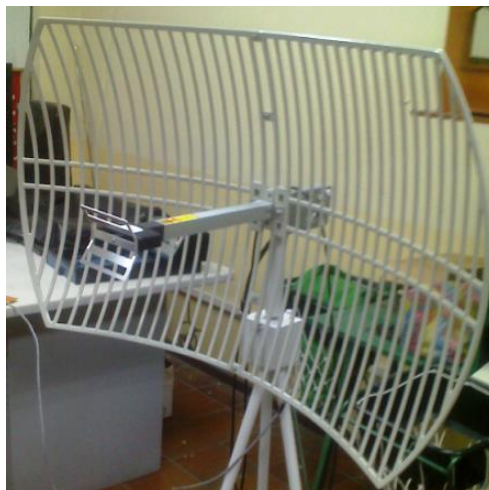
Figura 3.2.44. Antena Semi-parabólica utilizada en Transmisión a 2,45 GHz.
