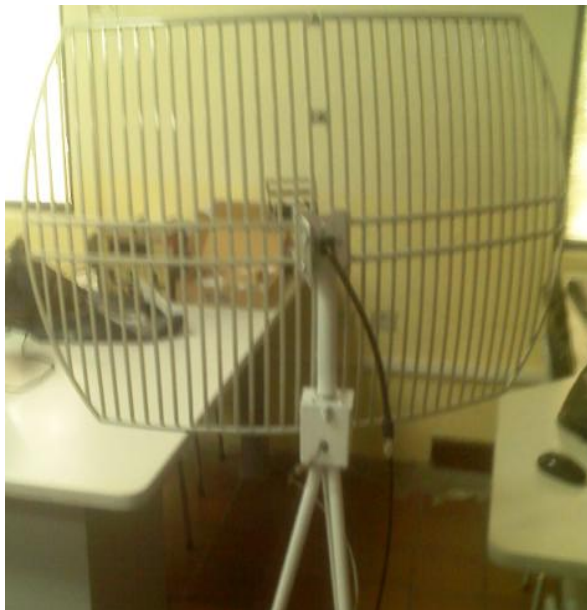
Figura 151. Antena parabólica como transmisora.
