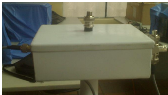
Figura 3.1.12. Caja de soporte de Antenas PCB y de Base de celular.
