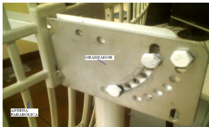
Figura 3.1.17. Graduador de inclinación de la antena parabólica.
