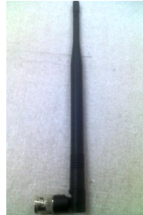
Figura 3.2.21. Antena Dipolo B.C. utilizada en Transmisión y recepción a 914 GHz.
