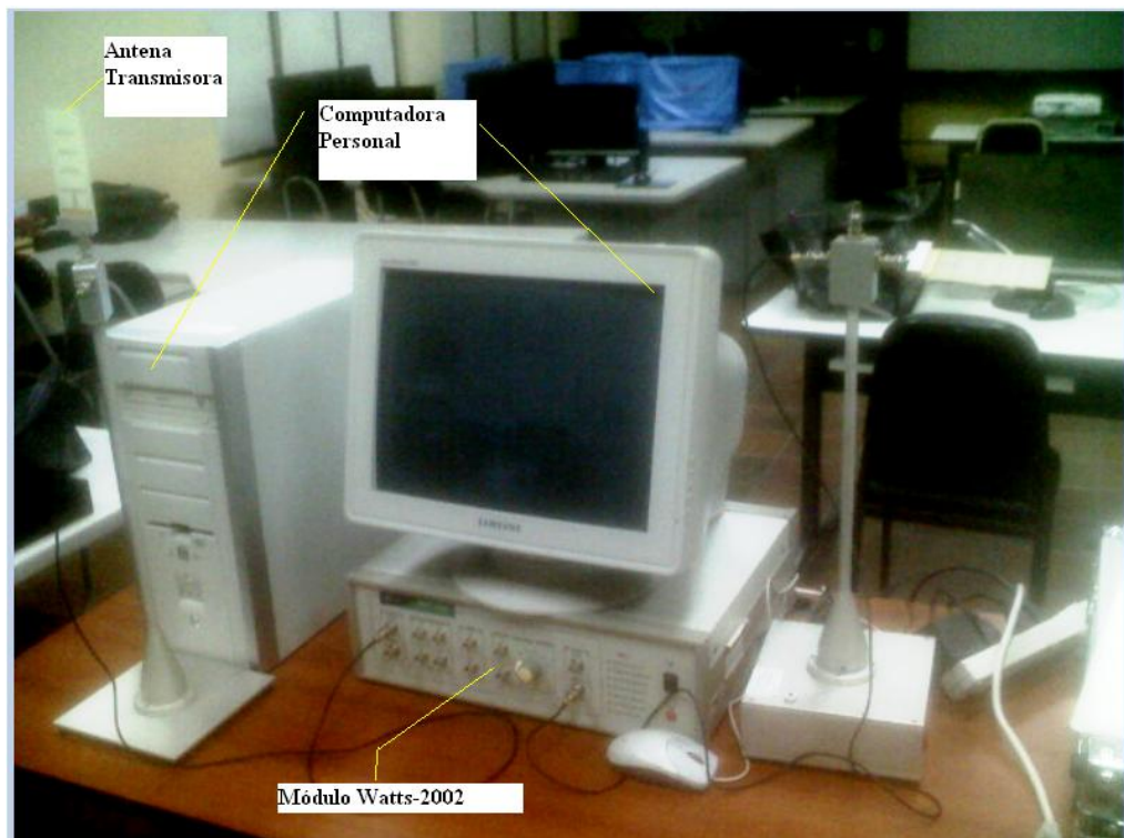
Figura 3.1.2. Sistema de transmisión RF.
