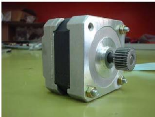
Figura 2.4.1. Motor Paso a Paso utilizado en el proyecto.
