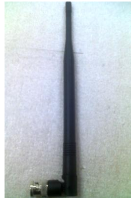
Figura 3.2.11. Antena Dipolo B.C. utilizada en transmisión y recepción a 2,45 GHz 1
