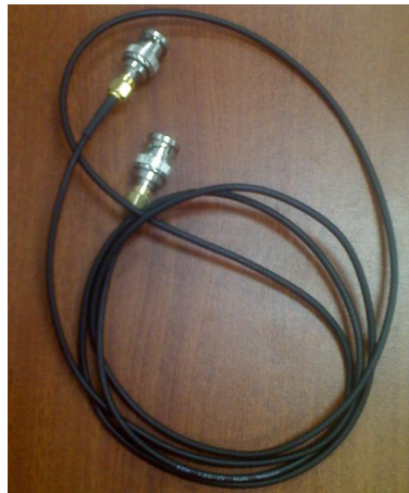
Figura 3.1.8. Cable coaxial para conexión de generador y soporte de conexión de la antena transmisora.
