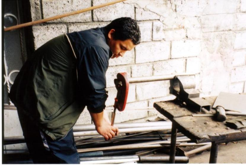
**Figura 5-9 Cortando tubo interior del silenciador.**
