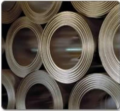
**Figura 3-1 Cilindros de acero laminado en frío.**
