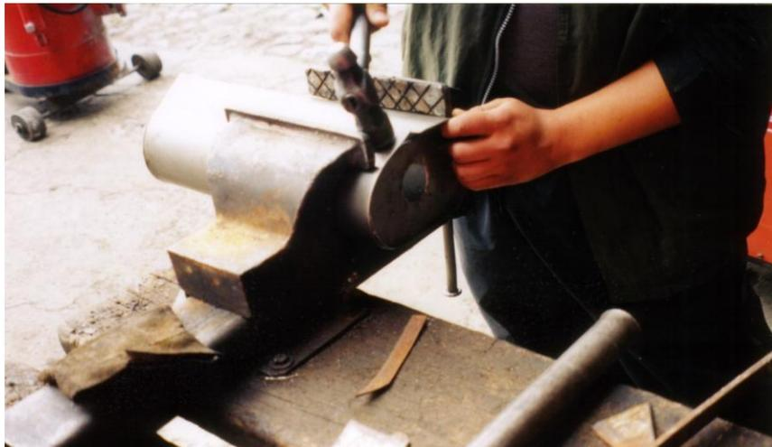
**Figura 5-13 Cilindro listo para unión.**
