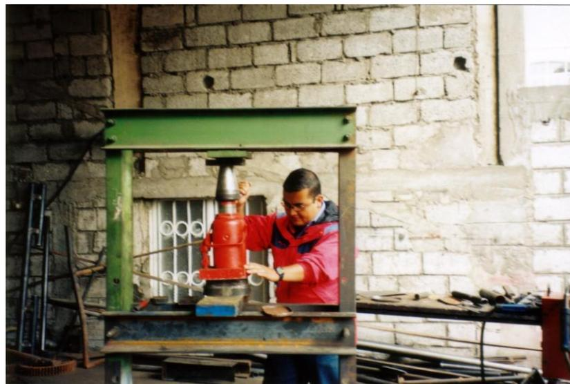
**Figura 5-7 Prensado de compartimentos del silenciador.**
