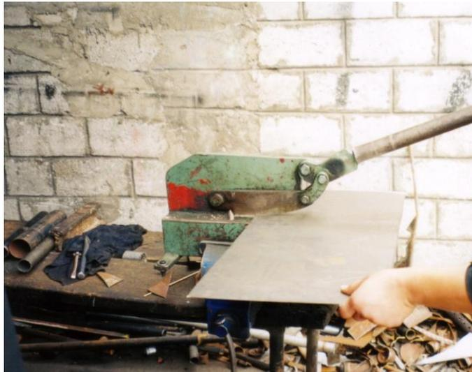
**Figura 5-2 Corte de plancha principal.**
