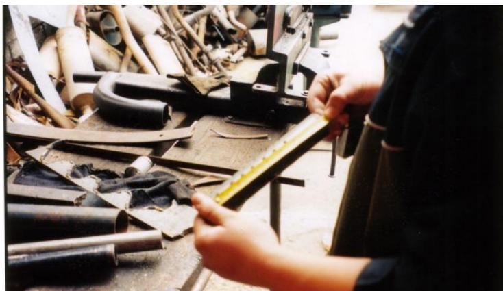
**Figura 5-1 Señalización de tubo interior.**
