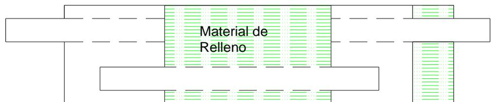
FIGURA 1-8 Silenciador combinado de absorción y reflexión
