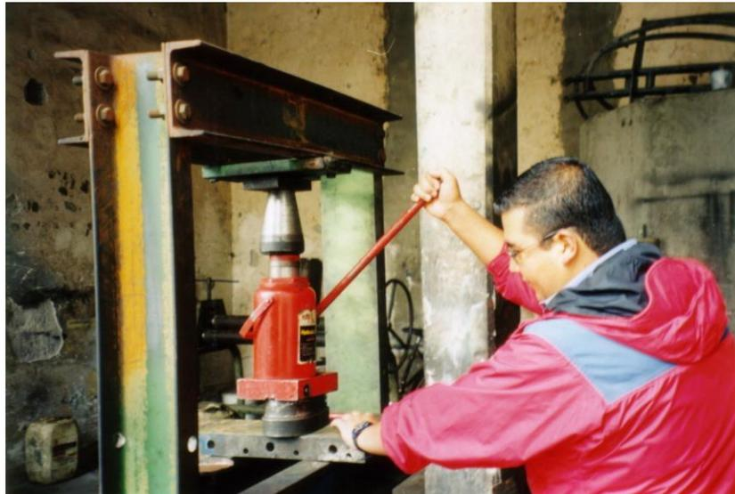
**Figura 5-6 Prensado de tapas del silenciador.**
