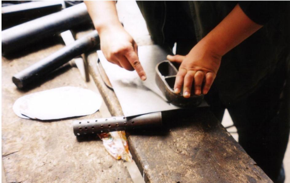
**Figura 5-14 Señalización de compartimientos para luego cortar.**
