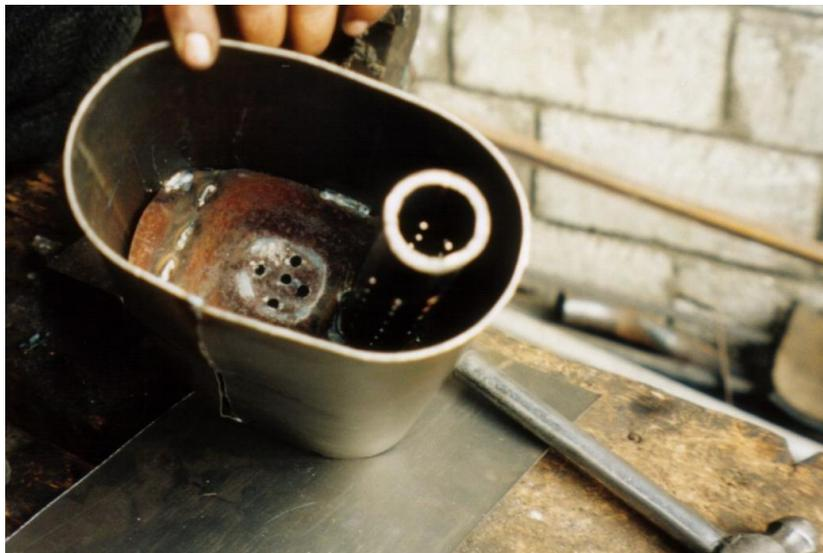
**Figura 5-17 Tubos y compartimientos ubicados en el interior del cilindro.**
