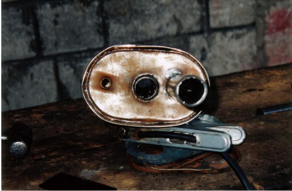
**Figura 5-19 Tapas listas para soldar con el cilindro.**
