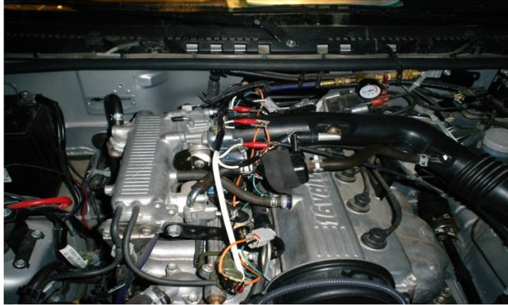
**Fig. 3.2:** Conexión del dispositivo con el sistema de inyección.
