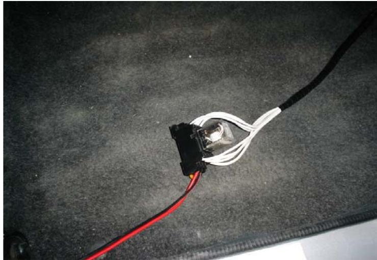
**Fig. 3.4:** Relay de control entre el sistema de seguridad y el sistema de inyección del auto.
